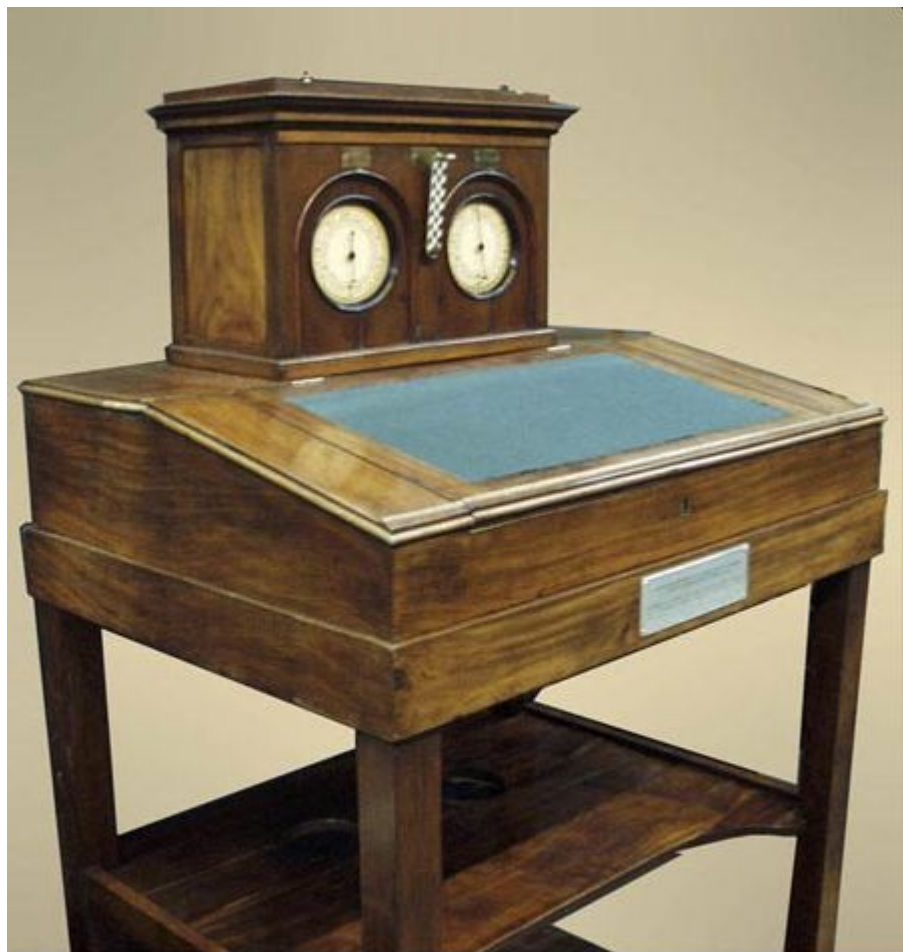
9. Стрелочный двухциферблатный телеграфный аппарат Б.С.Якоби. 1840-гг. Применялся на линии связи между кабинетом Николая I в Зимнем дворце и кабинетом главного управляющего путями сообщения П.А.Клейнмихеля на Фонтанке, 115.
