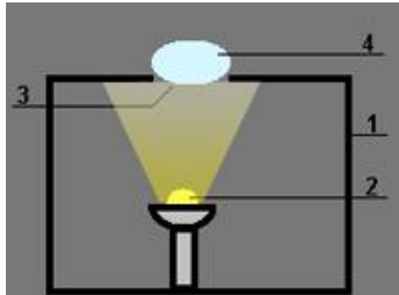
Рис.2. Устройство простейшего овоскопа: 1. Коробка; 2. Электрическая лампочка; 3. Отверстие; 4. Яйцо.
