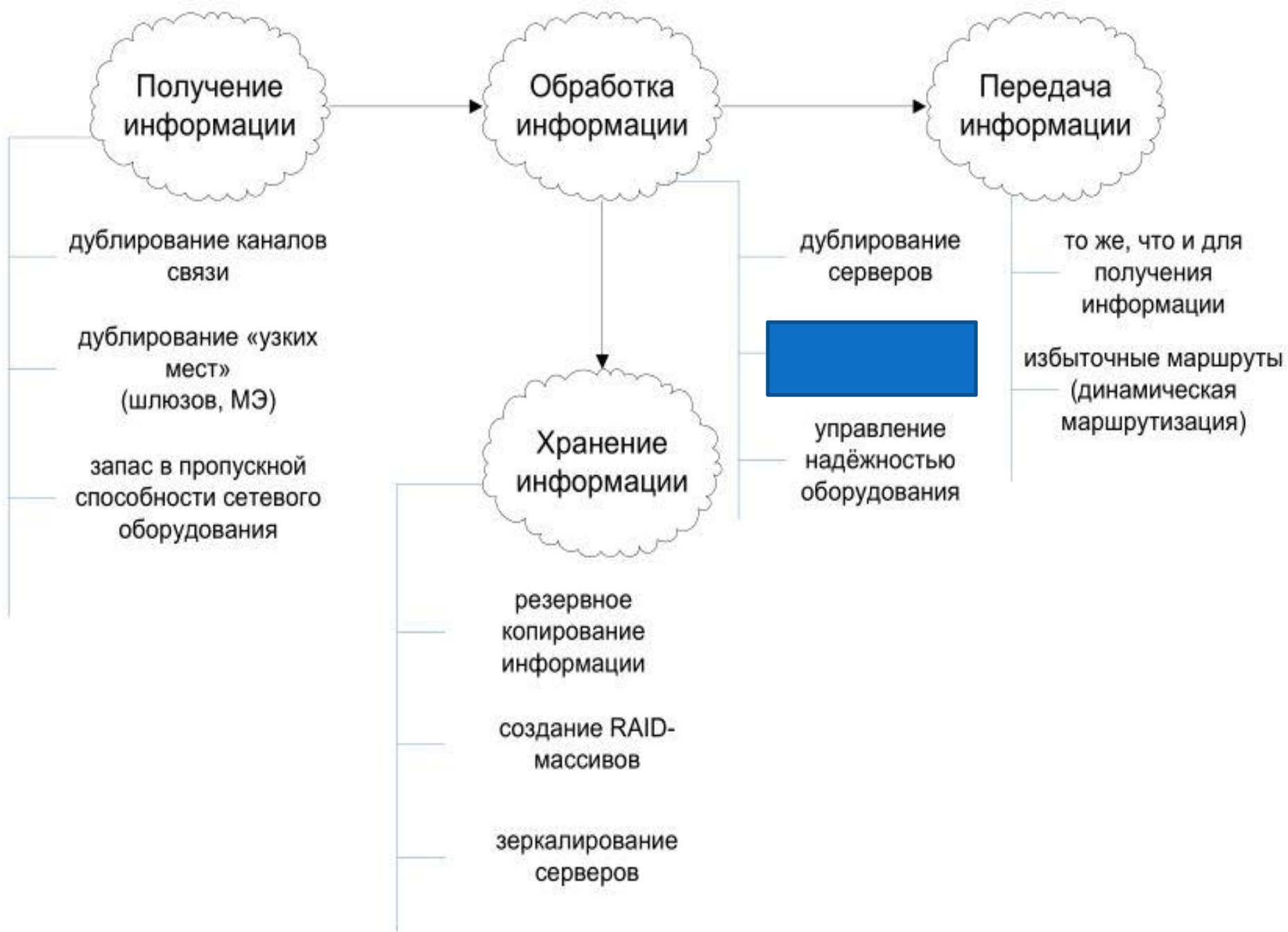
Рис. 1.5.1. Структура системы защиты от угроз нарушения доступности
