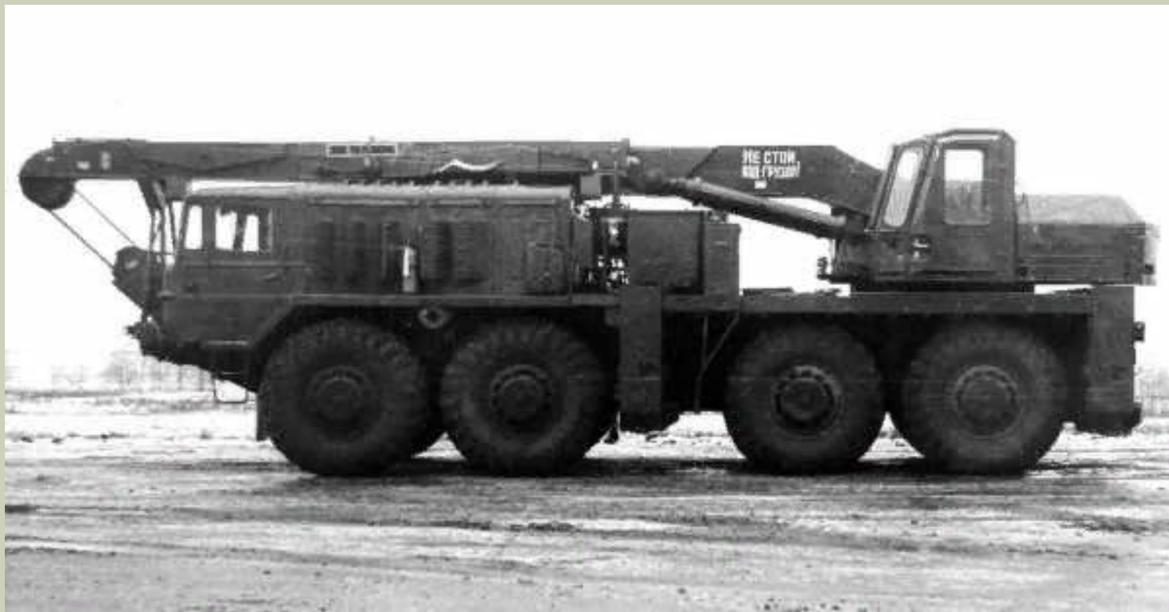
16-тонный войсковой автокран 9Т35 с телескопической стрелой на шасси МАЗ-537К. 1968 год
