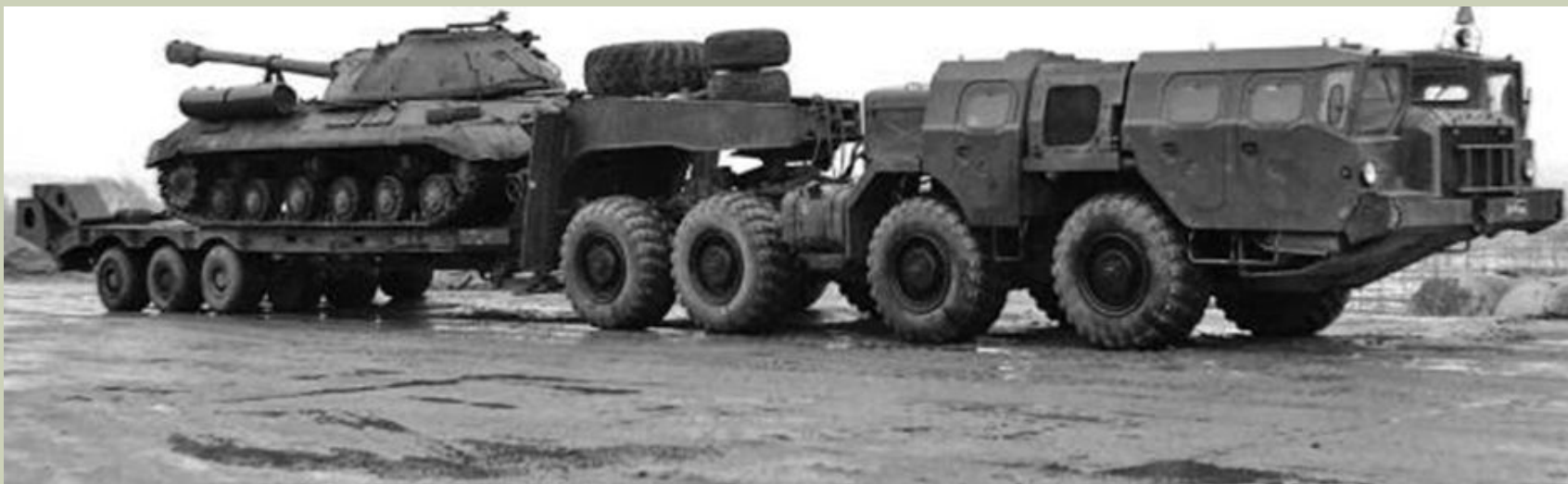
Тягач МАЗ-74101 «Оплот-Т» с боковой кабиной боевого расчета и полуприцепом МАЗ-796. 1975 год
