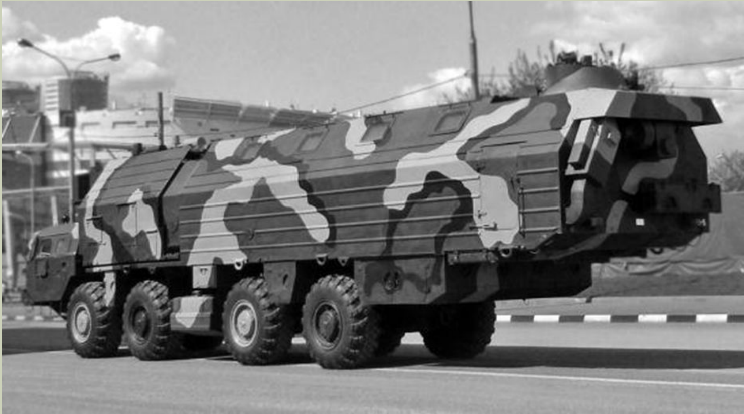
Комплексная машина боевого дежурства 15В148 с пулеметной башней на крыше задней части кузова
