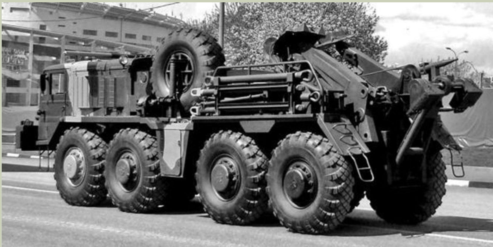
Тяжелый колесный эвакуационный тягач КЭТ-Т на шасси МАЗ-537Г. 1987 год
