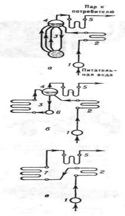
Схемы циркуляции воды, пароводяной смеси и пара в котельной установке: а - котёл с естествеяной циркуляцией; б котёл с многократной принудительной циркуляцией; в прямоточный котёл; 1 питательный насос; 2 - водяной экономайзер; 3 - циркуляционный контур; 4 - барабан; 5 пароперегреватель; 6 циркуляционный насос; 7 испарительная поверхность нагрева
