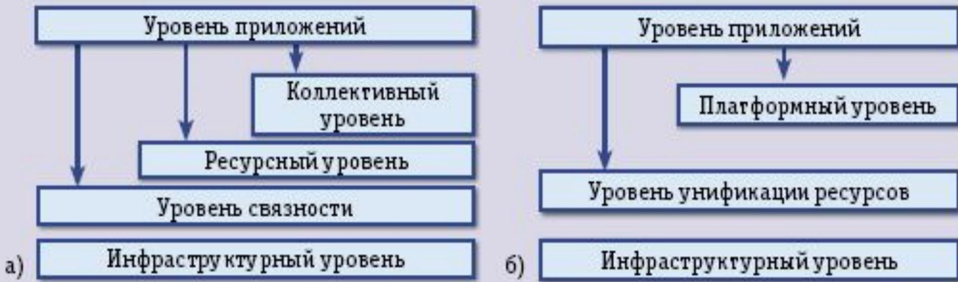
Сравнение архитектур grid (а) и cloud computing (б)
