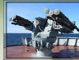
КУВ на базе КАМ «Стрелец» в составе автономного модуля самообороны корабля «Гибка» (2007г.), «Гибка-Р» (2008г.)
