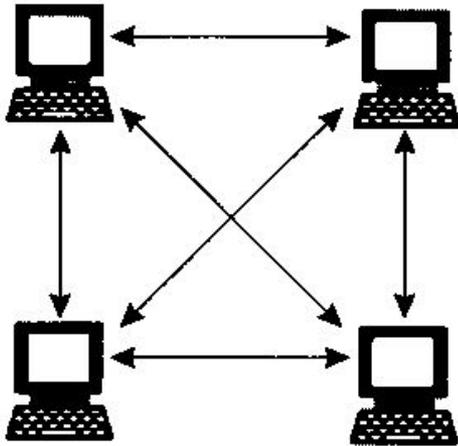
В случае *полносвязной топологии* каждый компьютер сети связан с каждым компьютером отдельным дуплексным (двусторонним) физическим каналом связи
