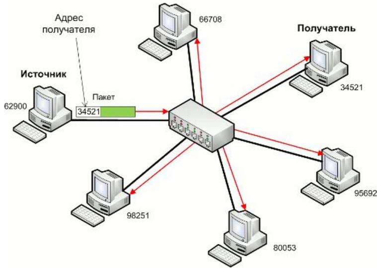
Концентратор (hub) – это сетевое устройство, предназначенное для объединения устройств сети в сегменты. Основной принцип его работы заключается в трансляции пакетов, поступающих на один из его портов на все другие порты.
