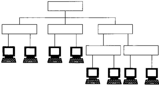
*Древовидная, или иерархическая, топология получается при объединении концентраторов нескольких звезд в иерархическом порядке. При этом возникает древовидная структура с одним путем передачи для каждого из компьютеров*
