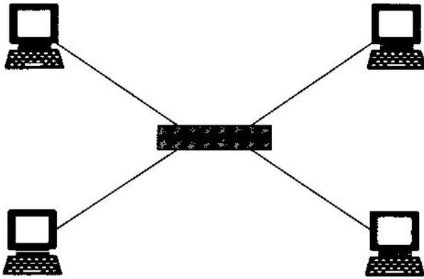
В *звездообразной* топологии каждый компьютер подключается при помощи отдельного кабеля к общему устройству, называемому *концентратором*, или *хабом*. В качестве кабеля в этом случае может быть использована как витая пара, так и коаксиальный либо оптоволоконный кабель. В качестве концентратора может выступать как специальное устройство, так и еще один компьютер.
