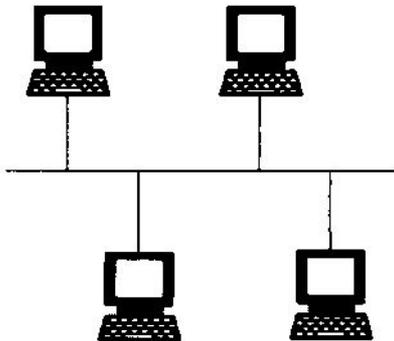
В качестве шины выступает обычно коаксиальный кабель, отрезками которого через специальные разъемы соединяются компьютеры
