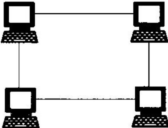
В *кольцевой* топологии компьютеры объединяются между собой круговой связью. При этом каждый компьютер связывается с последующим отдельным кабелем (нет общей шины). Это значит, что на каждом из компьютеров должно быть два сетевых устройства: для связи с предыдущим компьютером и с последующим.
