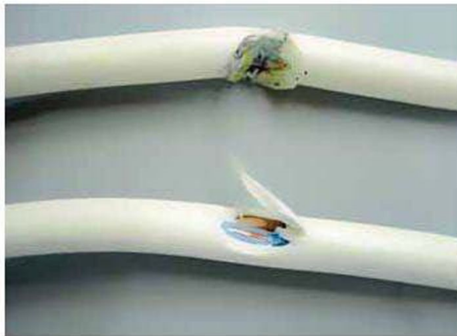
Мал. 191. Зовнішній вигляд проводу з пошкодженим ізоляційним шаром
