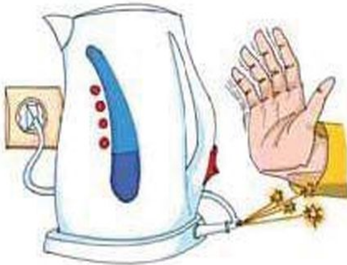
Мал. 192. Іскріння як ознака перегину та пошкодження шнура електричного живлення
