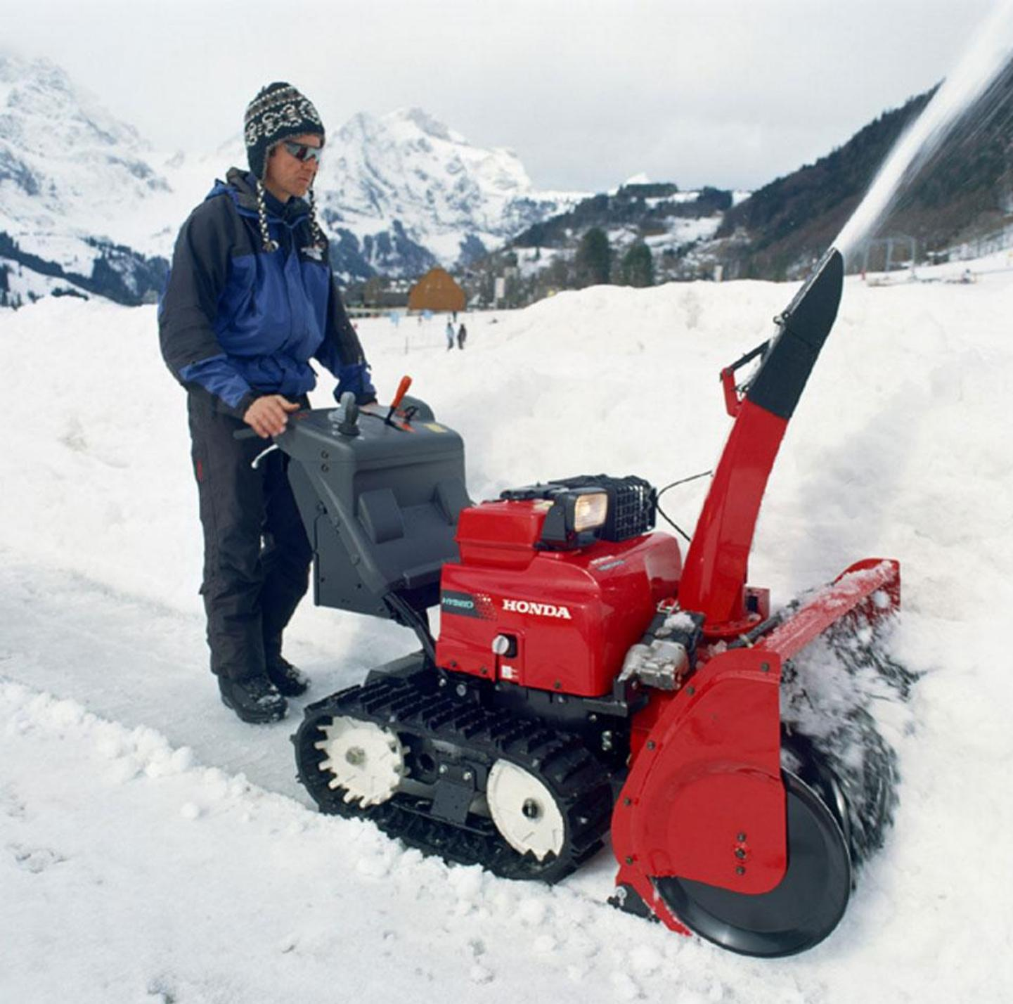
Для расчистки от снега небольших территорий, тротуаров и тропинок часто используются **самоходные шнекороторные снегоборочные машины.**
