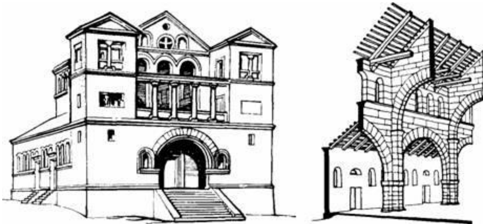
Базлика в Турманине (Сирия) V в. фасад, схема разреза
