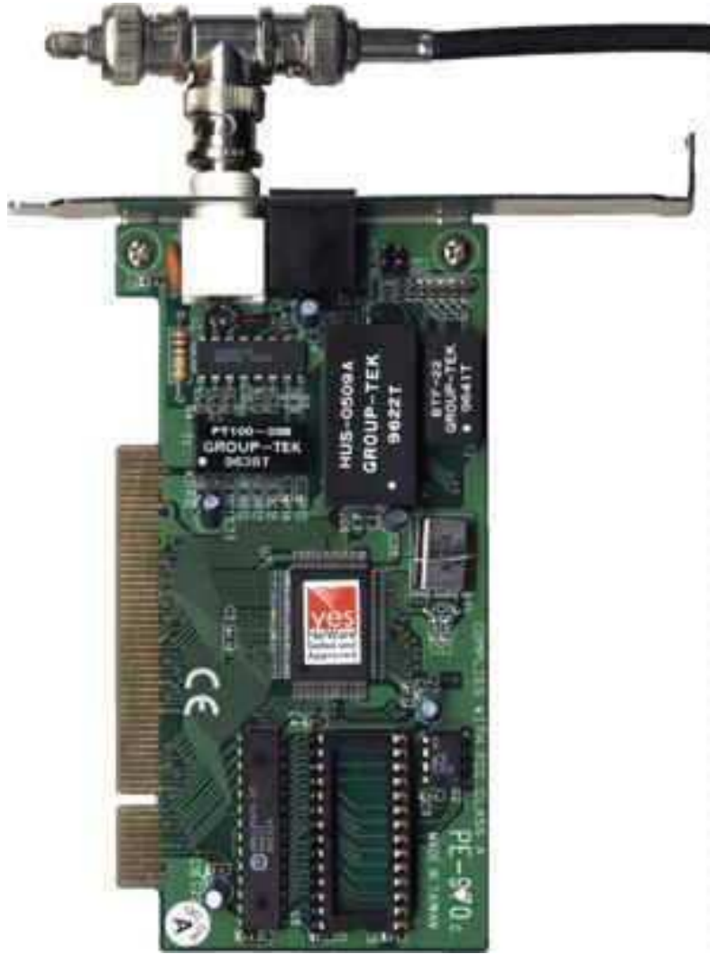
Рис. 2. Сетевое соединение на «тонком» Ethernet-кабеле (кабель необходимо терминировать на концах)
