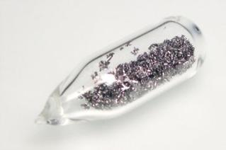
Электропроводность селена сильно повышается на свету. На этом свойстве селена основано устройство фотоэлементов и приборов для измерения интенсивности света наподобие фотоэкспонометров. Ксерокопирование также основано на использовании фотопроводимости селена.
