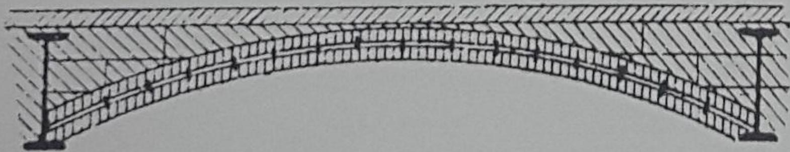
По опалубке сводики кладутся в  $\frac{1}{2}$  кирпича, на растворе ( 1 часть портланд-цемента, 1 часть песку) или же кладку производят на известково-цементном растворе (1-цемент, 1- известь, 6 – песок). Пятовые кирпичи должны быть притёсаны, чтобы плотно прилегать к балкам. Раскруживание сводов происходит через 10-14 дней. По сводам устраивают смазку из мусора или тощаго бетона, а по ней укладываются лаги.
