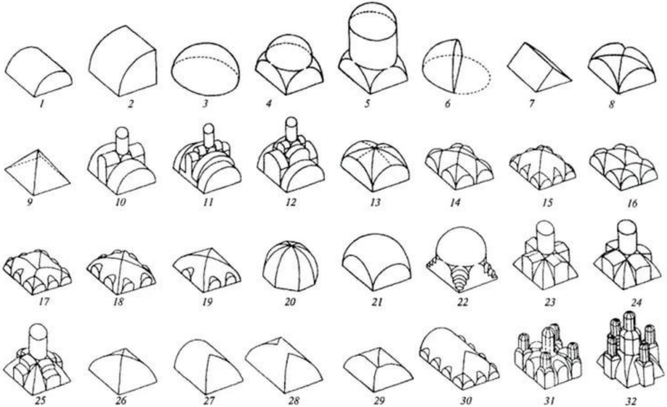
• **Бочарный свод, свод двойкой кривизны** — поверхность свода образуется движением плоской кривой, образующей по кривой направляющей.
