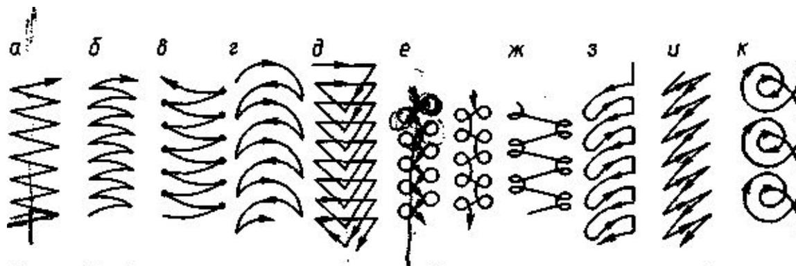
**Рис. 4.3.** Основные виды траекторий поперечных движений конца электрода при слабом (а, б), усиленном (в — ж) прогреве свариваемых кромок, усиленном прогреве одной кромки (з, и), прогреве корня шва (к)
