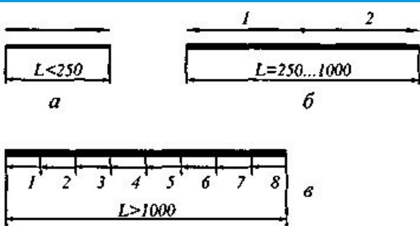
**Рис. 70. Способы выполнения швов различной длины:**
