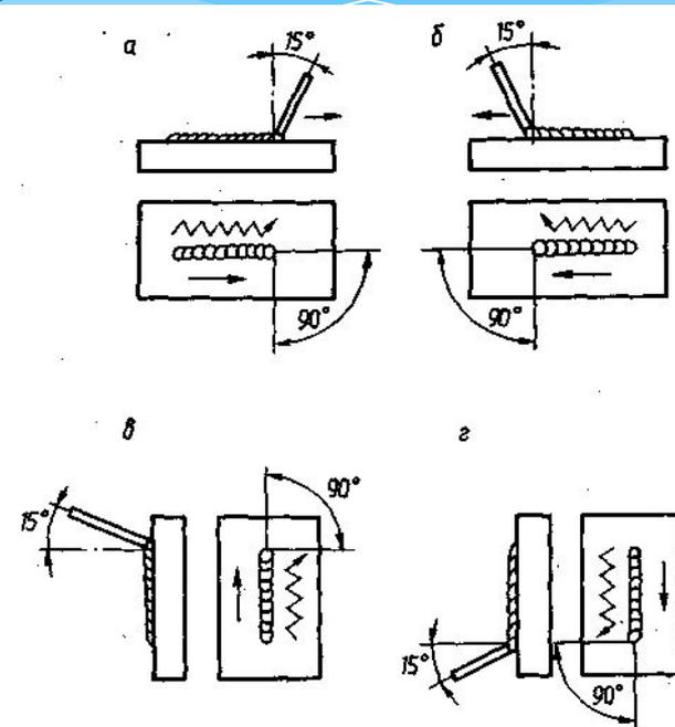
Рис. 4.2. Направление сварки:
