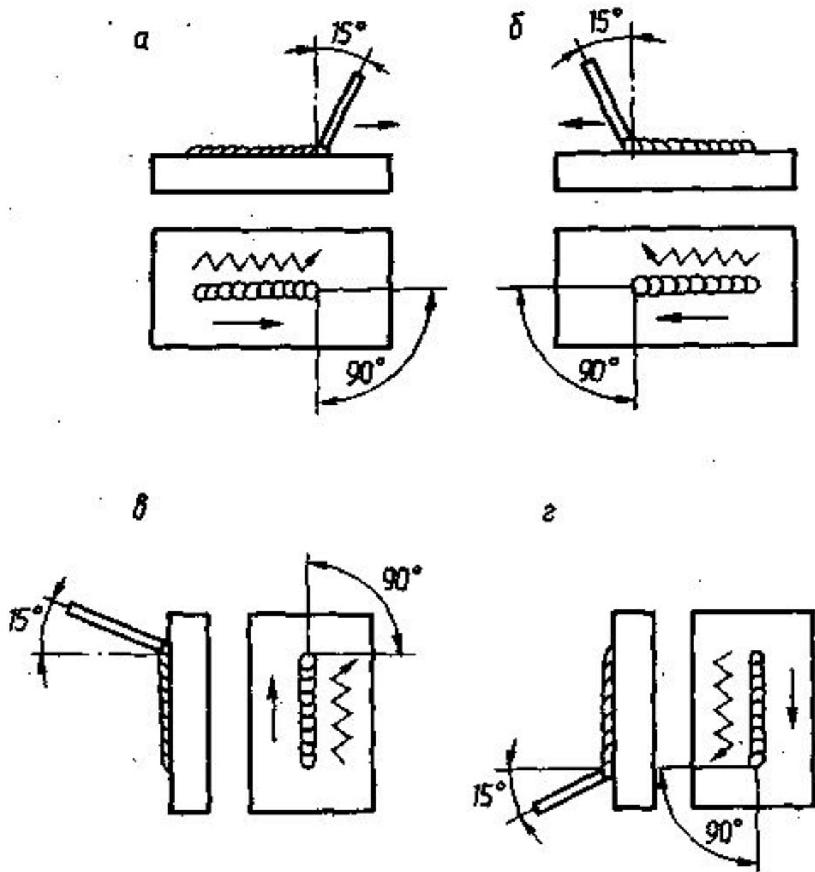
**Рис. 4.2. Направление сварки:**
