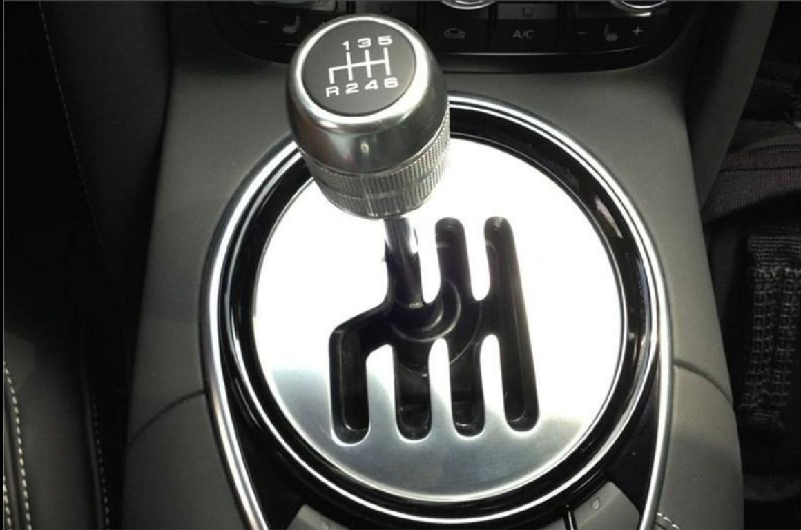
**Механическая коробка передач с ручным переключением** состоит из набора шестерен. Изменение передаточного числа осуществляется путем введения их в зацепление в различных сочетаниях. К плюсам данной коробки следует отнести высокий КПД, простоту, низкую цену, высокую динамику и наименьший расход топлива по сравнению с остальными коробками. Из недостатков следует отметить неудобство управления, особенно при движении в городе.
