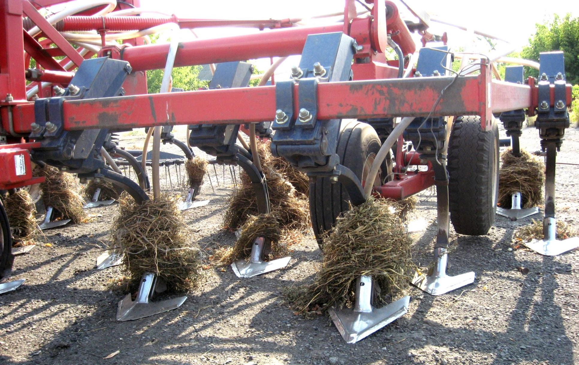
Сеялка-культиватор «Морис-Концепт 2000» оснащённый наплавленными лапами.
