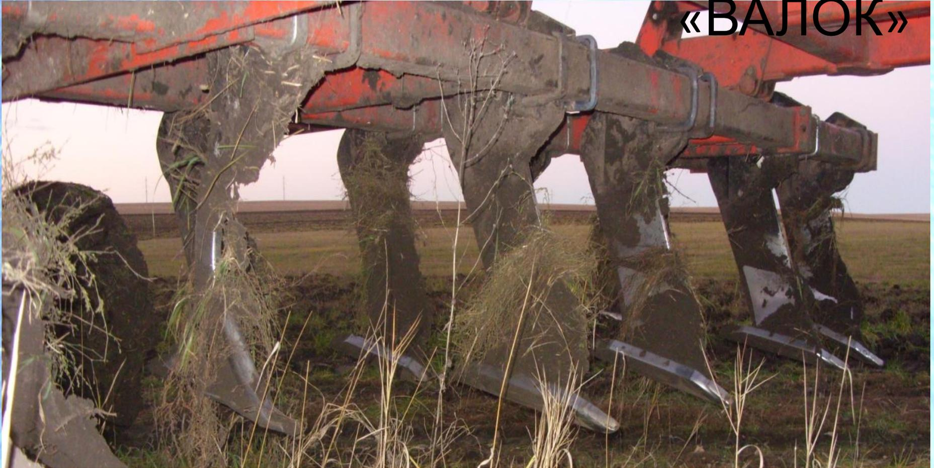
Полевые испытания упрочнённых долот глубокорыхлителя.
