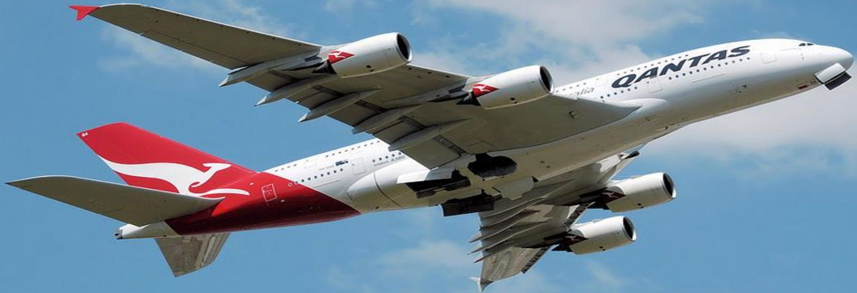
Airbus A380 — широкофюзеляжный двухпалубный четырехдвигательный турбореактивный пассажирский самолёт, созданный концерном «Airbus S.A.S.» — крупнейший серийный авиалайнер в мире. Вместимость — до 853 пассажира в одноклассовой конфигурации. Может совершать беспосадочные перелёты на расстояние до 15 400 км.
