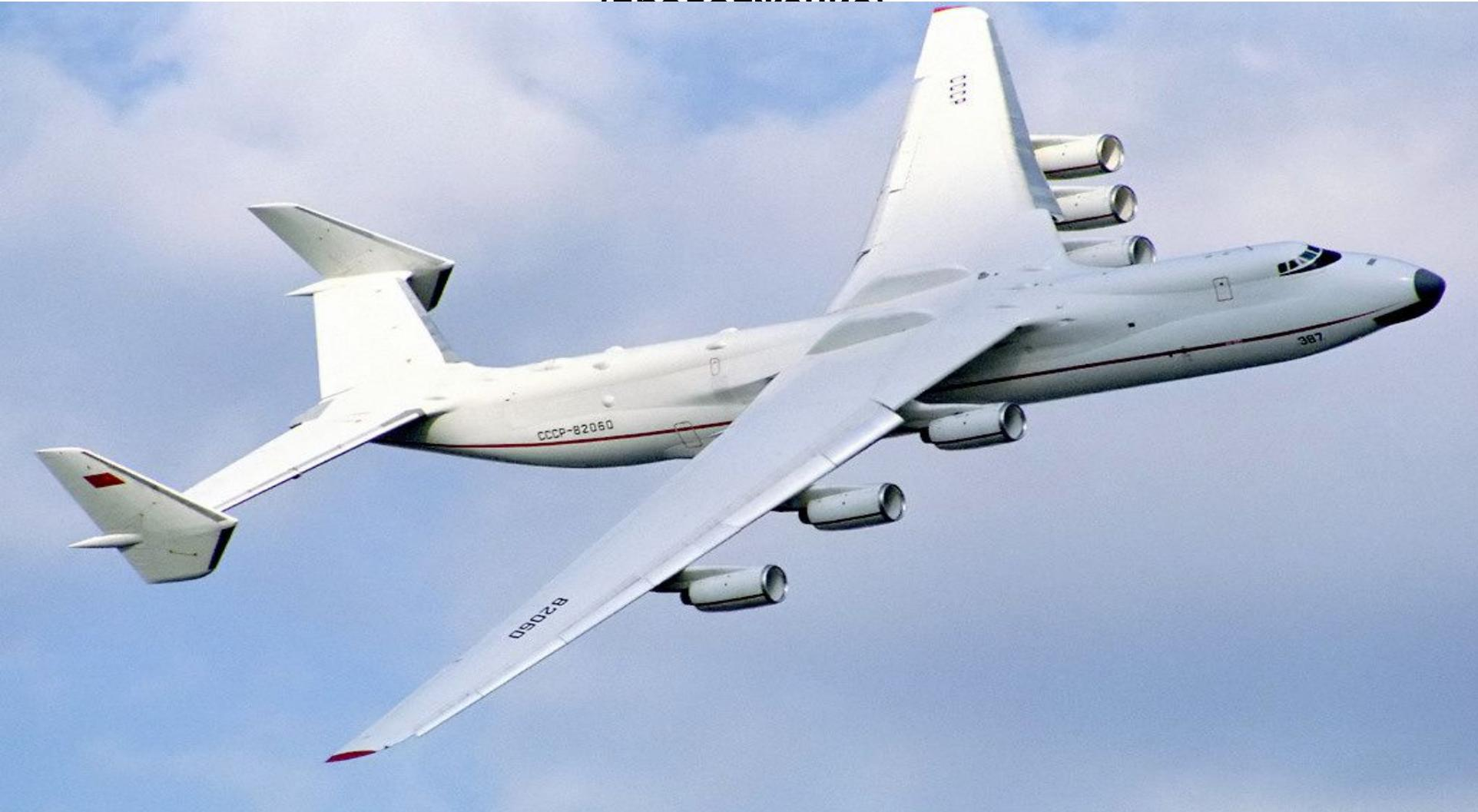
**Ан-225 «Мрія»— транспортный самолёт сверхбольшой грузоподъёмности разработки ОКБ им. О. К. Антонова (грузоподъёмность до 250 000 кг).**
