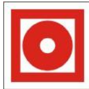
F 10 Кнопка включения установок (систем) пожарной автоматики
