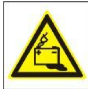
W 20 Осторожно. Аккумуляторные батареи
