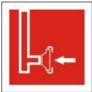
F 08 Пожарный сухотрубный стояк
