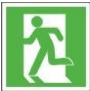
Е 01-01 Выход здесь (левосторонний)
