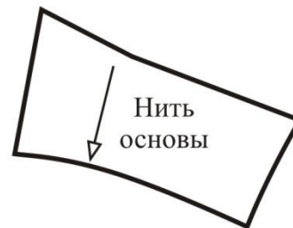
Верхняя часть дополнительного слоя бортовой прокладки
