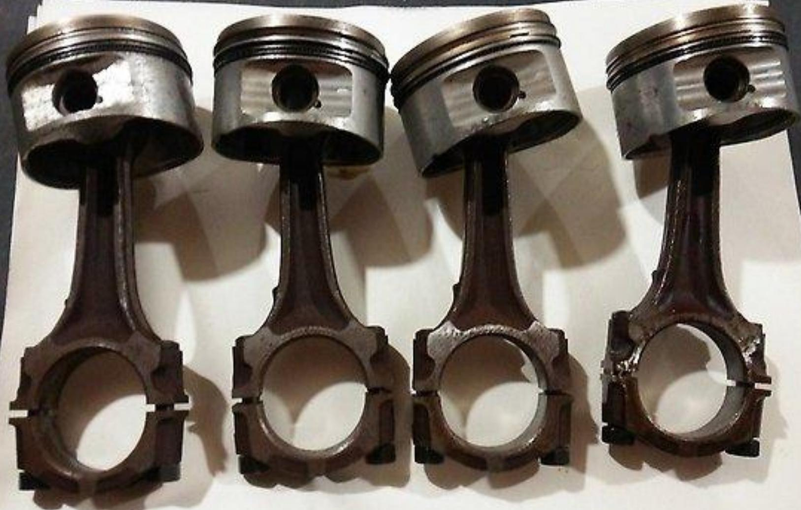
В стержне *шатуна* при принудительном смазывании плавающего поршневого пальца (в основном у дизелей) сверлится сквозное отверстие — масляный канал.
