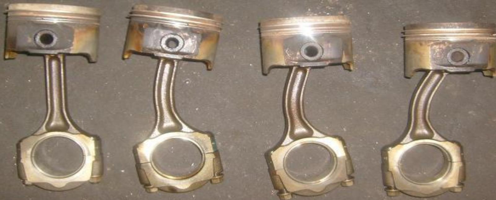
При работающем двигателе в бобышках поршня возможны стуки пальцев из-за различных значений коэффициента линейного расширения алюминиевого сплава и стали.
