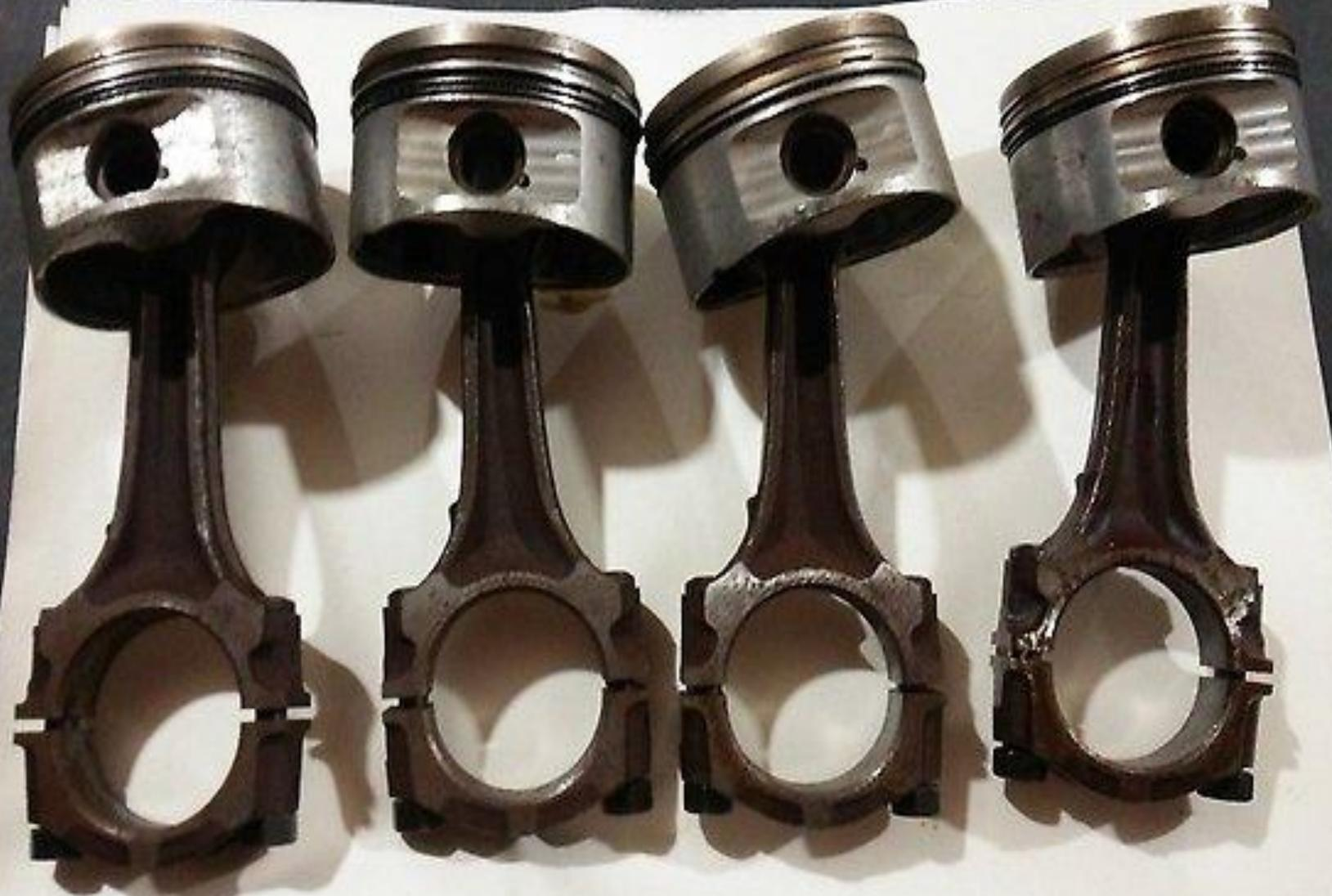
**Шатуны изготавливают из легированных или углеродистых сталей с последующей цементацией или закалкой токами высокой частоты (ТВЧ).**
