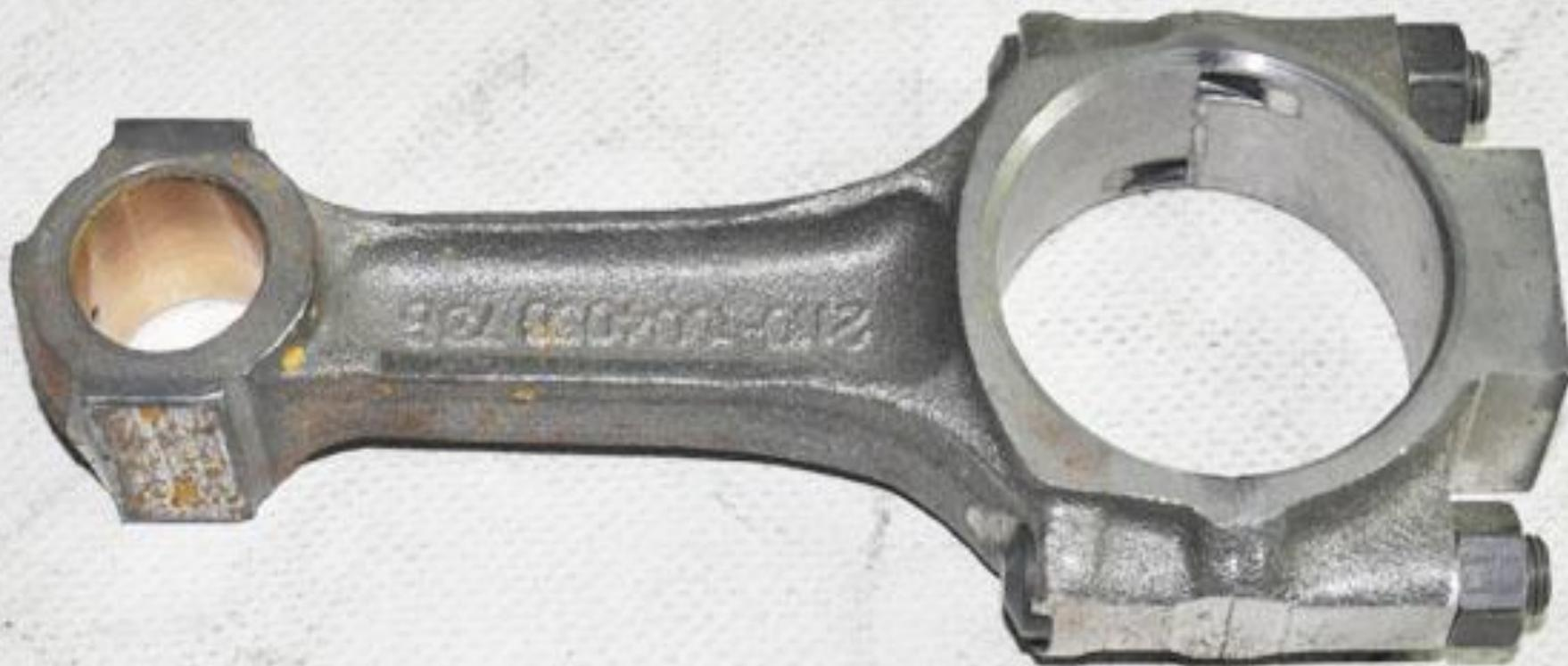
Шатун предназначен, для соединения поршня с кривошипом коленчатого вала и обеспечивает при рабочем ходе передачу усилия от давления газов на поршень к коленчатому валу, а при вспомогательных тактах (впуск, сжатие, выпуск), наоборот, — от коленчатого вала к поршню.
