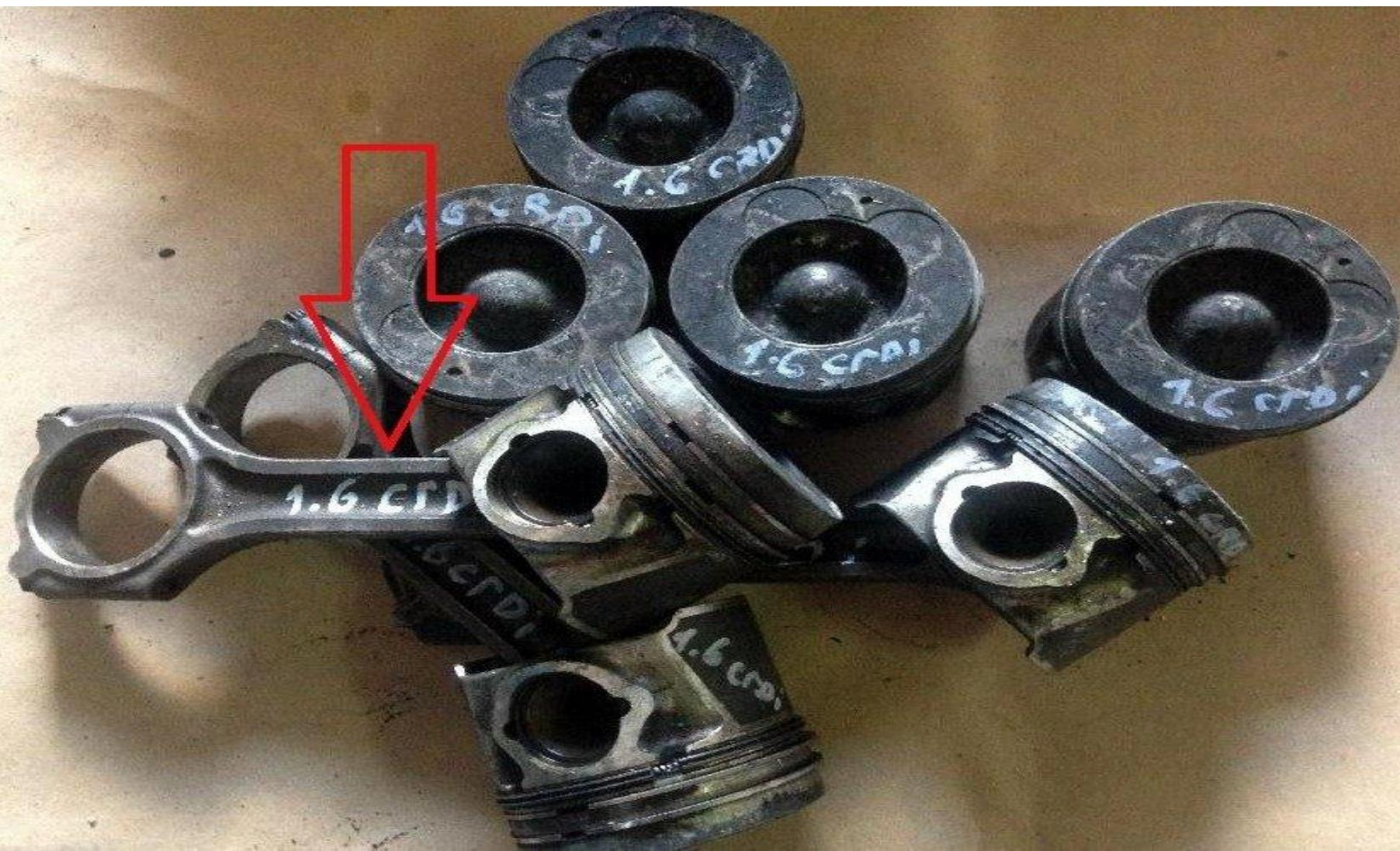
Осевое перемещение поршневого пальца ограничивается стопорными кольцами расположенными в выточках бобышек поршня.
