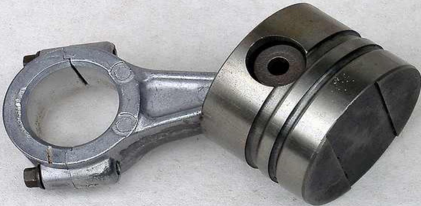
По способу соединения с шатуном и поршнем пальцы подразделяются на плавающие и на закрепленные (обычно в головке шатуна).
