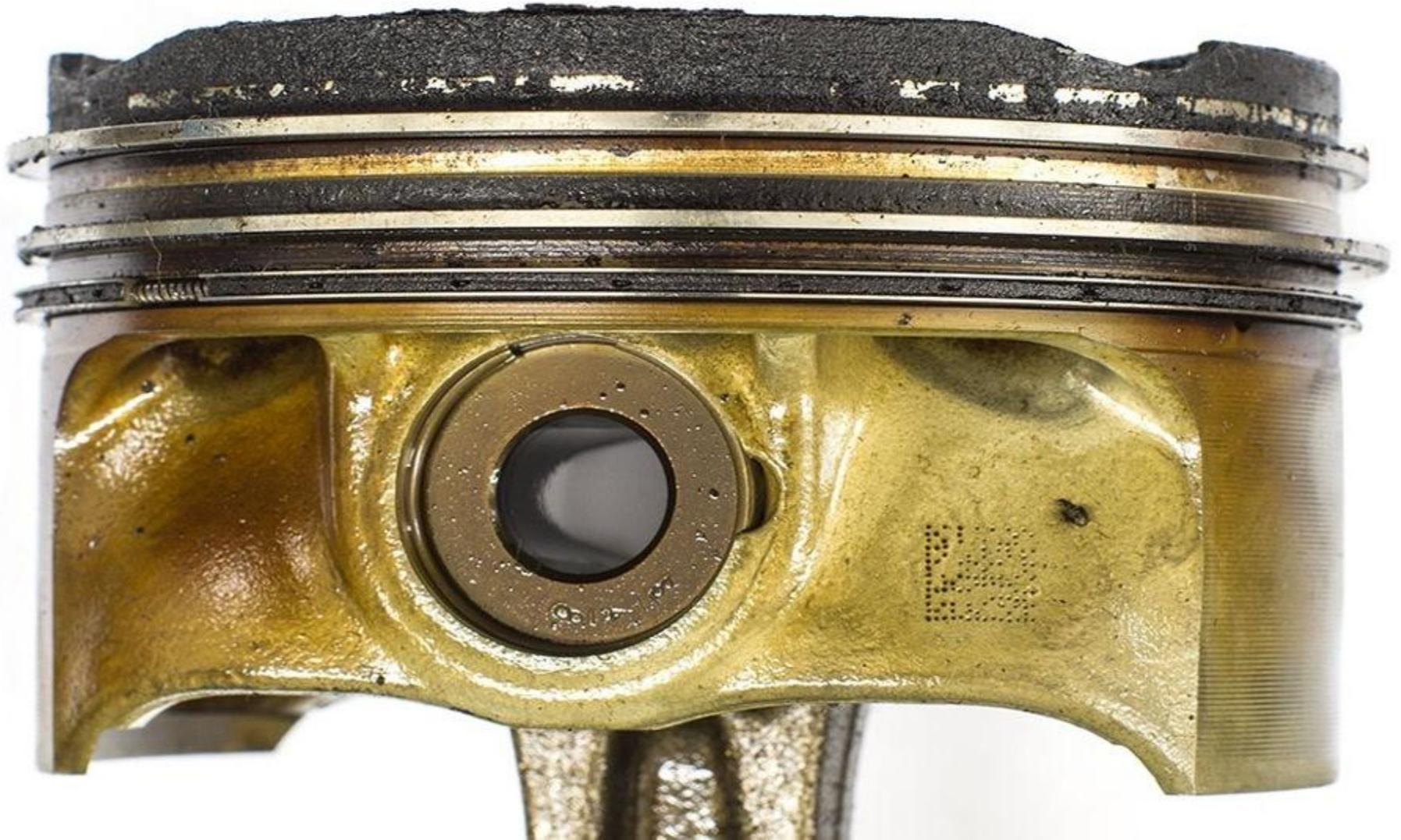
Наибольшее распространение получили плавающие поршневые пальцы, которые свободно поворачиваются в бобышках и втулке, установленной в верхней головке шатуна.
