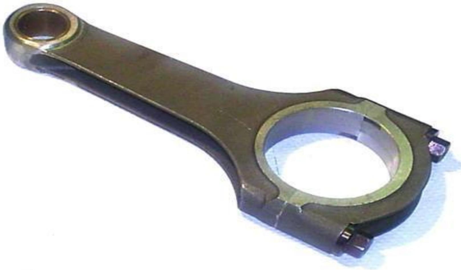
Шатун штампуют из легированной или углеродистой стали. Он состоит из стержня *двутаврового сечения*, *верхней головки*, *нижней головки* и *крышки*.
