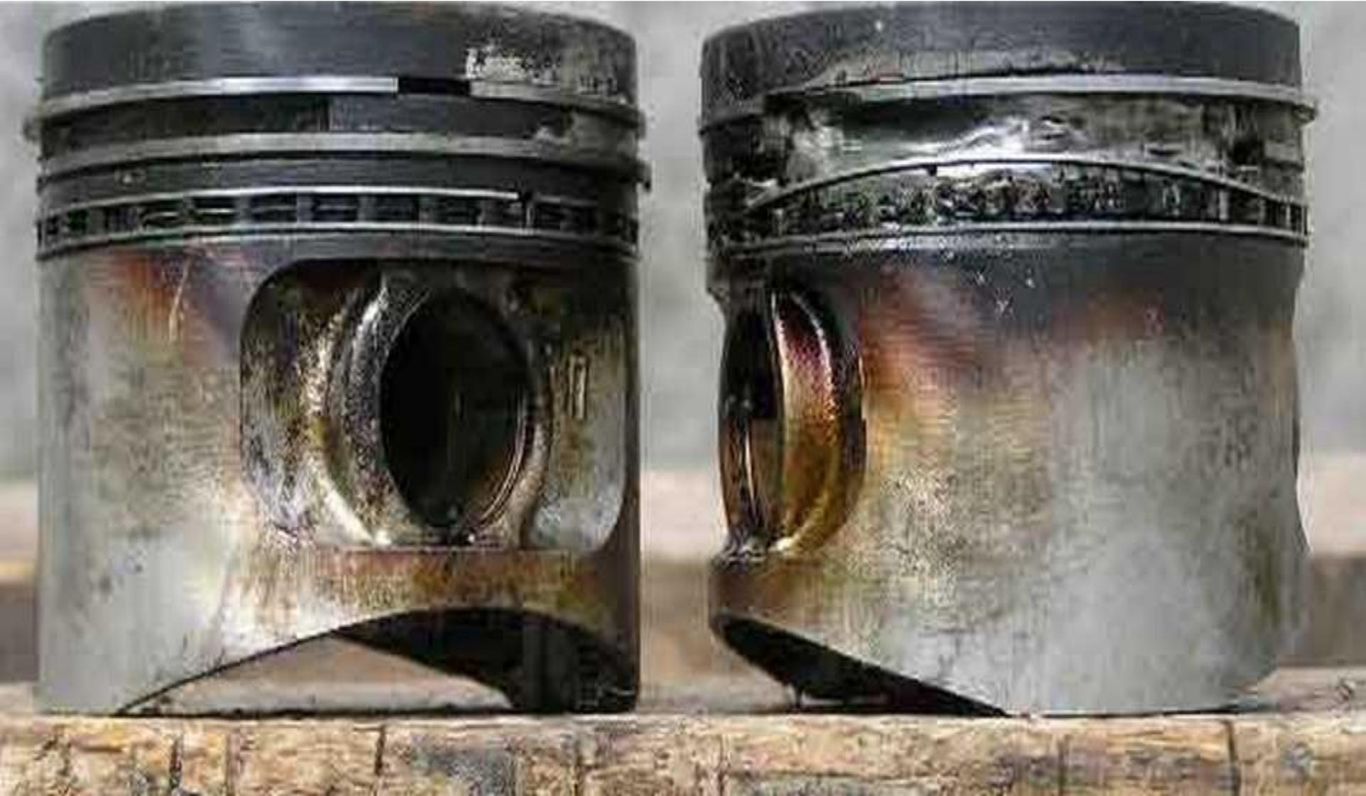
Рабочая смесь воспламеняется на впуске и горит на всех тактах рабочего цикла, скорость горения рабочей смеси в цилиндре увеличивается до 1500 м/с, ДВС перегревается поршни, цилиндры ГБЦ раскаляются, плавятся и заклинивают. От перегрева могут разрушаться клапана, свечи, форсунки, падать в цилиндр и разбивать поршни и ГБЦ.
