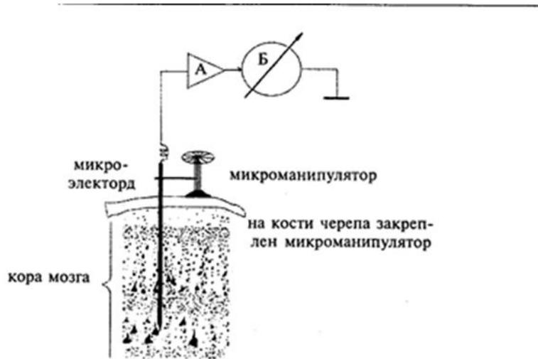
Рис. 8. Схема, поясняющая способ регистрации экстраклеточной активности нейронов.
