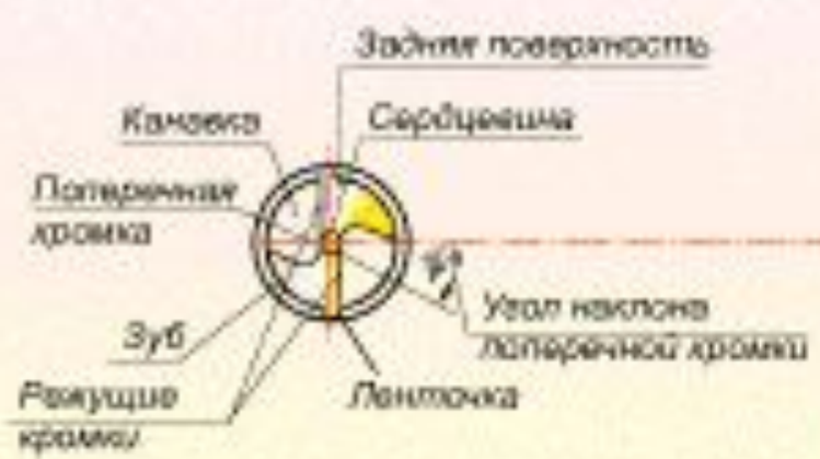
а - сверло с конусом Морзе; б - сверло с цилиндрическим хвостовиком; в - элементы сверла
