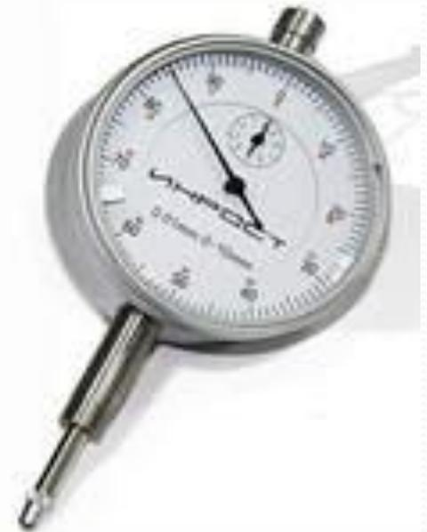
Рис. 4. Индикатор часового типа
