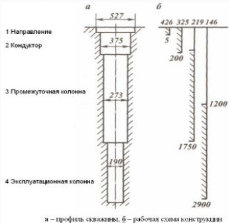
Рисунок - Конструкция скважины глубиной 2900 м
