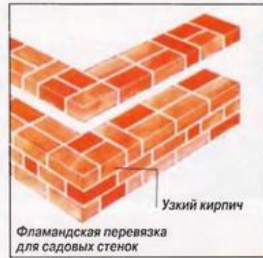
Рис. И. Здесь показан модифицированный вариант фламандской перевязки. Он характерен тем, что около каждого третьего ложка данного ряда расположен тычок, находящийся посередине ложка нижнего ряда.
