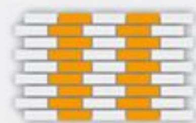
Ложковая кладка - смещение на 1/4 кирпича
