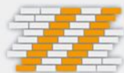
Ложковая кладка - косое смещение на 1/4 кирпича
