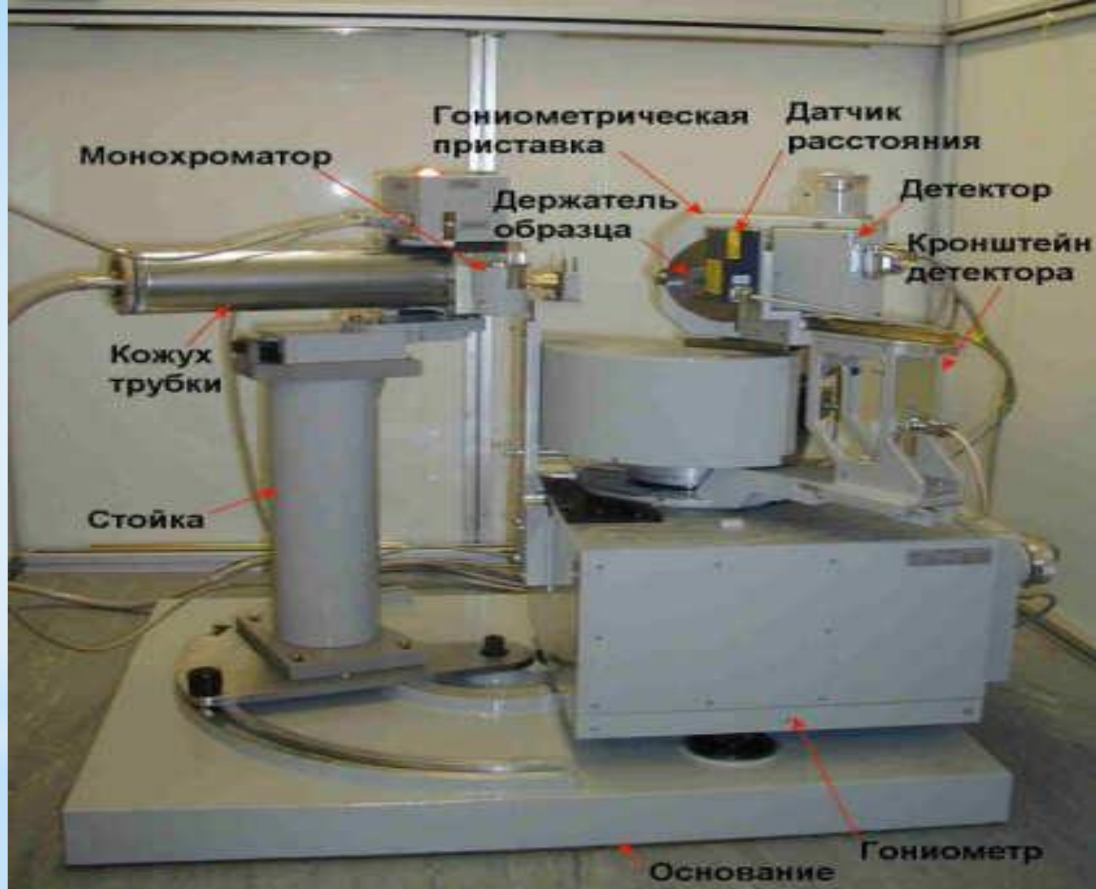
Трехкружный гониометр на базе ГУР-8.
