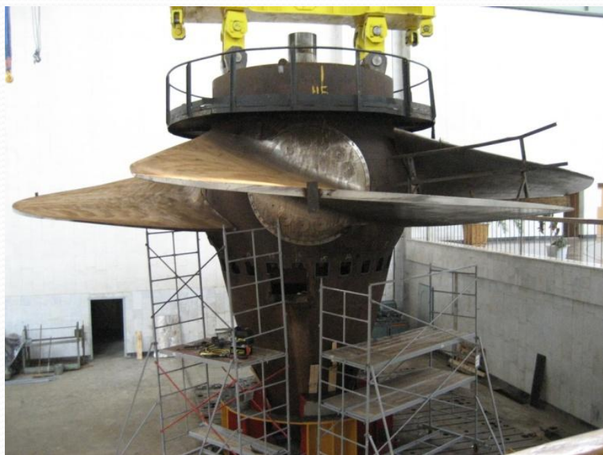
Бұрылатын қалақты турбинаның жұмыс дөңгелегі
