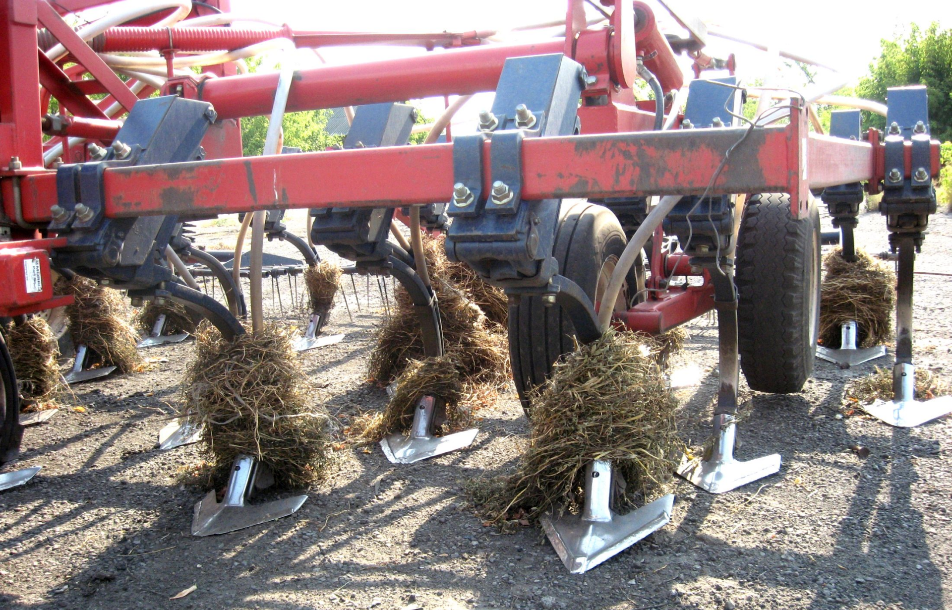
Рис. 6. Сеялка-культиватор «Морис-Концепт 2000» оснащённый наплавленными лапами.
