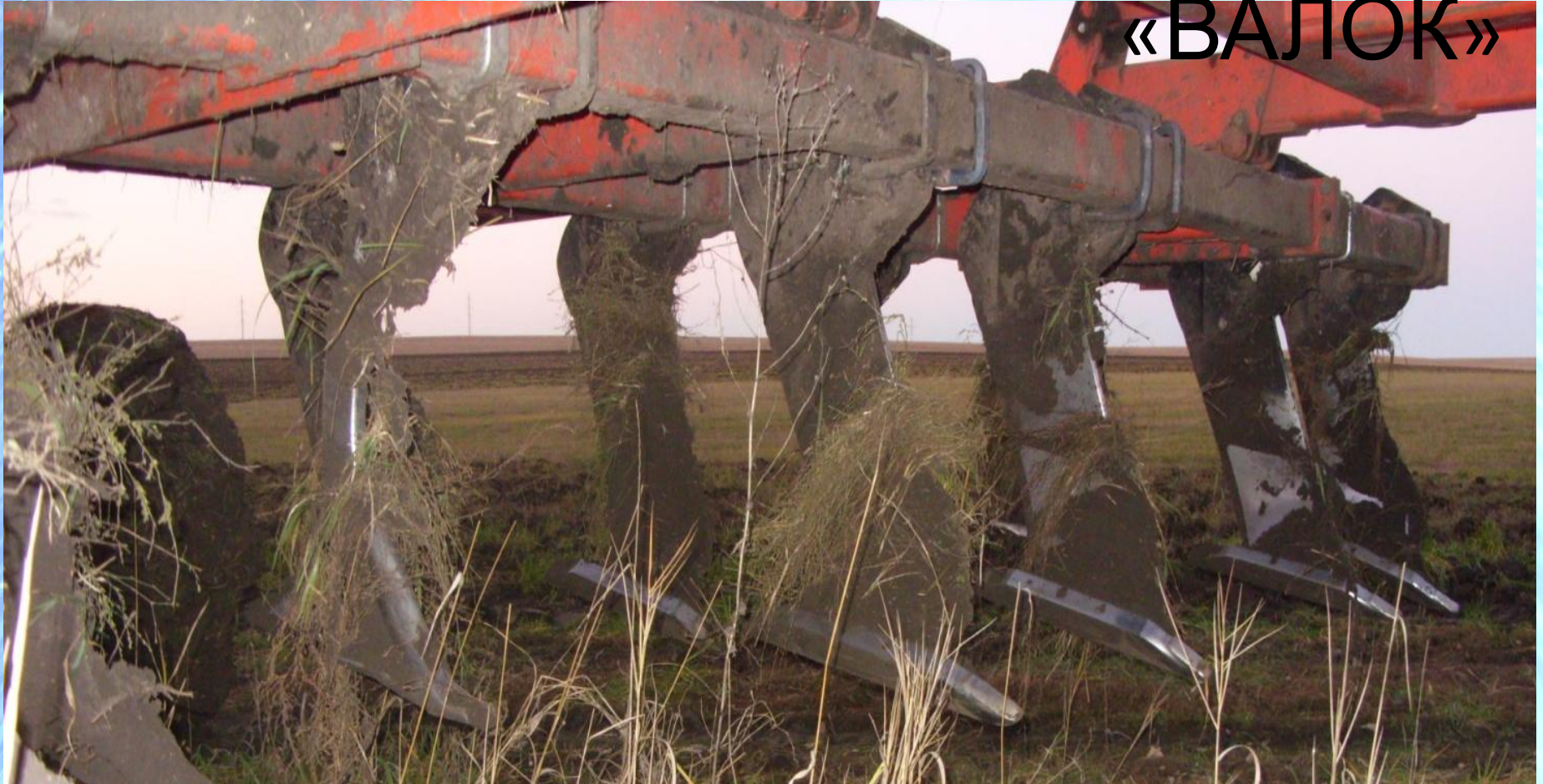
Рис. 8. Полевые испытания упрочнённых долот глубокорыхлителя.
