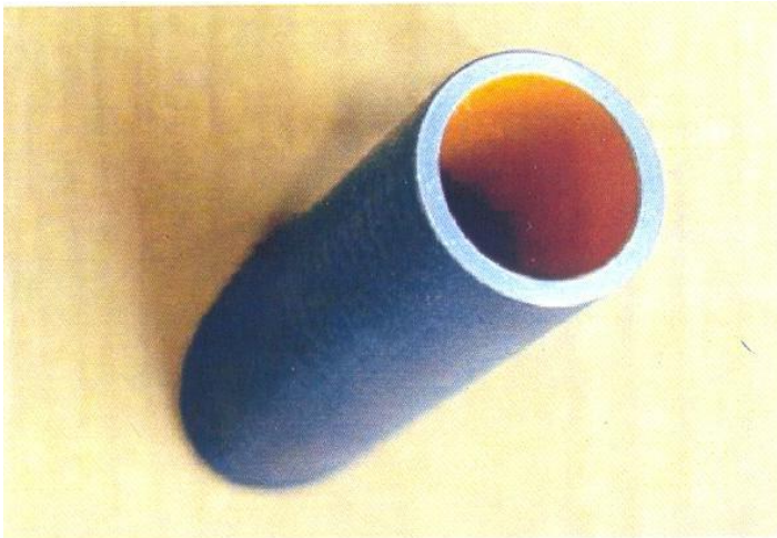
Рис. 4. Обрез трубы из ВЧШГ.
