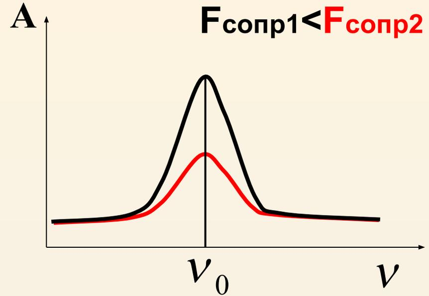
**Резонанс** – явление резкого возрастания амплитуды колебаний при совпадении частоты внешней силы и собственной частоты колебаний системы.
