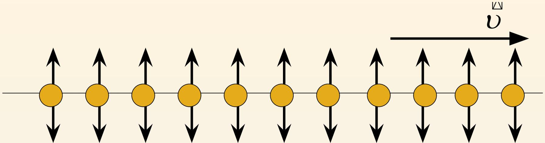
**Поперечная волна** – это волна, в которой колебания происходят перпендикулярно направлению распространения волны. Поперечные волны могут распространяться в твердых телах и на границе двух сред.
