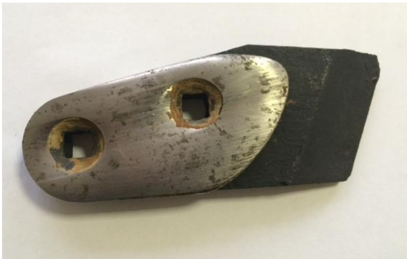
Вид нового и изношенного накладных долот лемехов Сталь Б1500 до и после наработки 8 га в СПК «Кузьминский».
