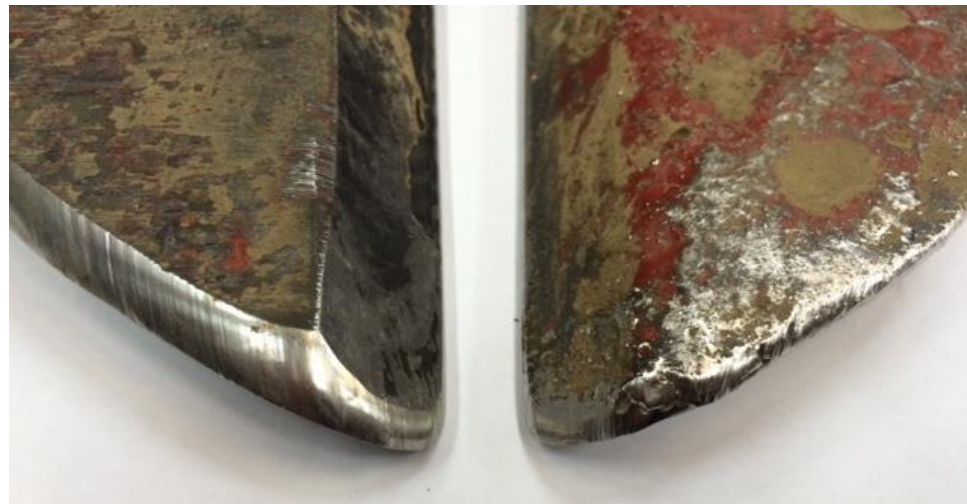
Вид ненаплавленного (слева) и наплавленного (справа) лемехов Сталь Б1500 после наработки 5 га на корпус (СПК «Кузьминский»).
