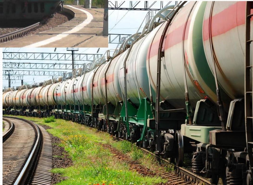
Транспортирование энергоносителей по железной дороге производится в специальных цистернах или в крытых вагонах в таре.
