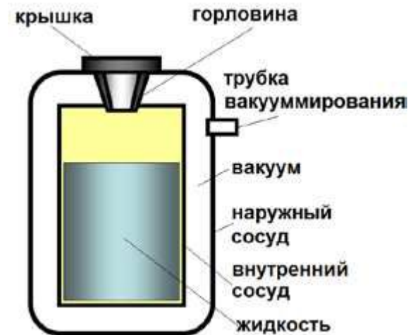
Сосуд Дьюара как изолированная система
