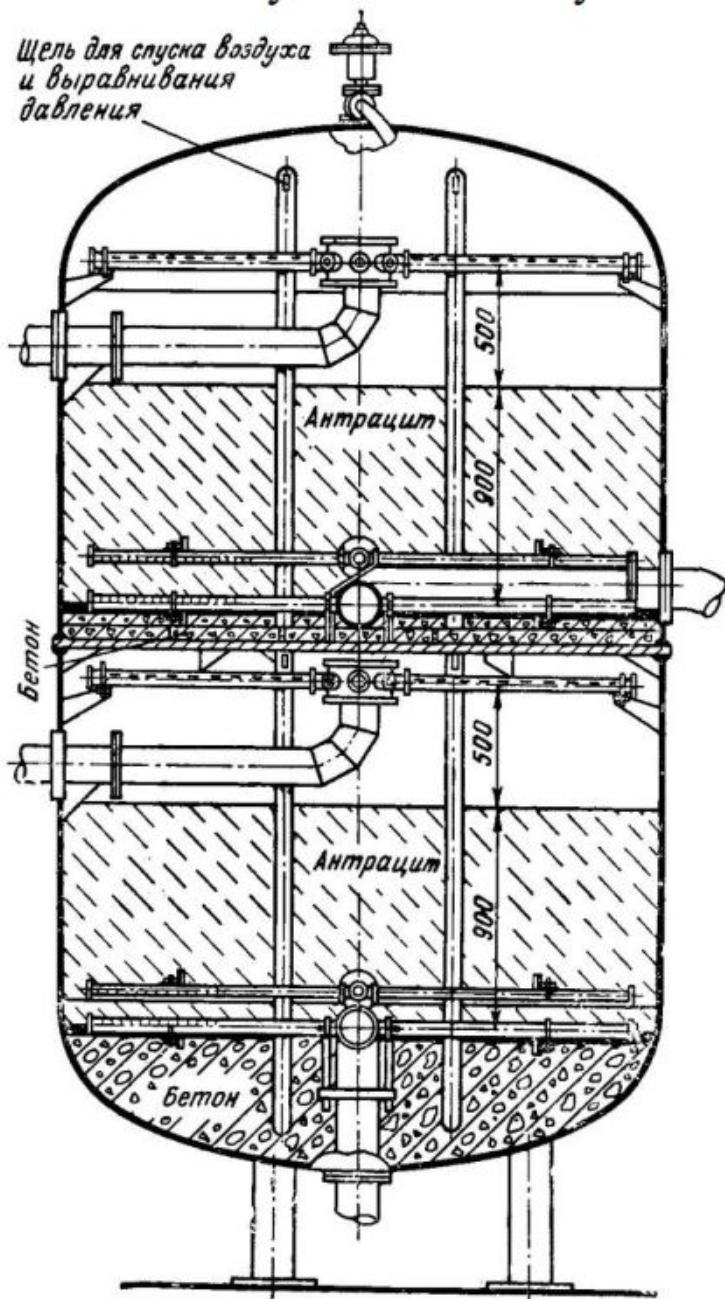
Двух- и трехкамерные фильтры разделены на две или три камеры плоскими промежуточными днищами, рассчитанными из условия возможного перепада давлений в соседних камерах, равного 1 атм. Плоские днища имеют анкерные трубы для обеспечения необходимой жесткости. В этих трубах в верхних зонах камер имеются щели для выравнивания давления в камерах фильтров. На верхнем сферическом днище установлен вантуз для автоматического удаления воздуха из фильтра.
