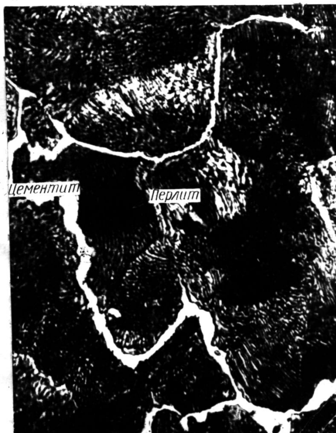
Рис. 4. Микроструктура заэвтектоидной стали (1,2 % C), \times 200
