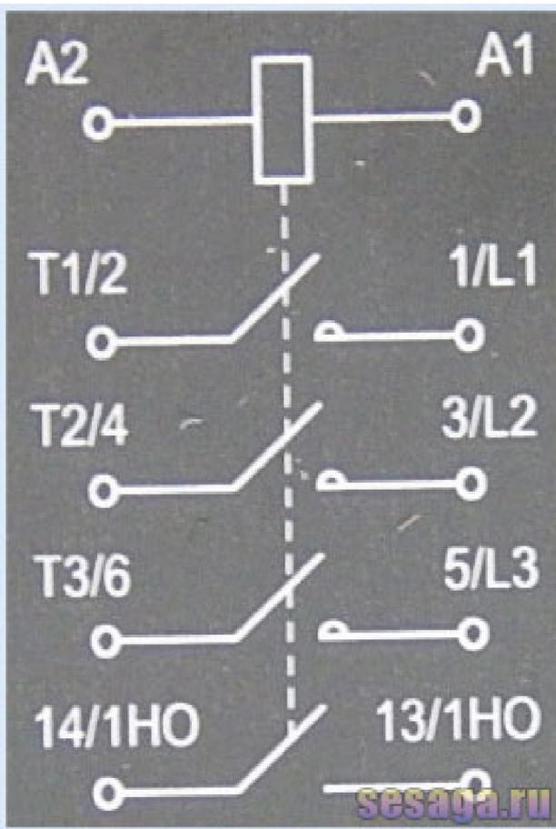
Здесь показана электрическая схема контактора: катушка и четыре пары нормально открытых контактов – три силовых (рабочих) и один вспомогательный. От катушки через все контакты проходит пунктирная линия, которая указывает, что все четыре контакта замыкаются и размыкаются одновременно.
