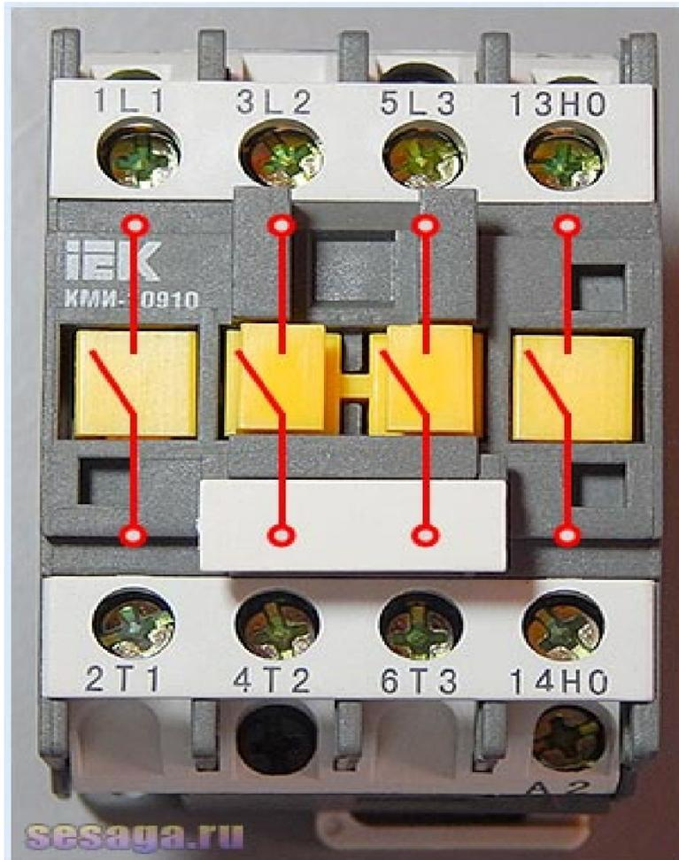
Последняя пара контактов 13НО–14НО является вспомогательной и эту пару используют для реализации в схеме самоподхвата контактора. То есть, эта пара нужна, чтобы при включении в работу, например, двигателя, все время его работы не пришлось держать нажатой кнопку «Пуск».
