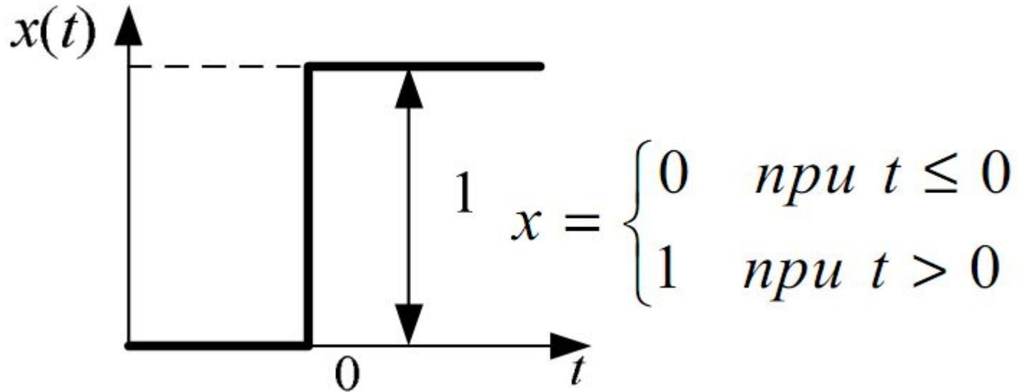
**Скачок** – единичное ступенчатое входное воздействие  $x(t)$ , которое часто возникает в системе при её включении (отключении) и/или резком изменении заданного режима.
