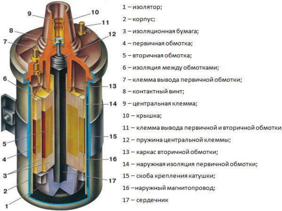
Различают следующие типы катушек зажигания: общая, индивидуальная и сдвоенная.
