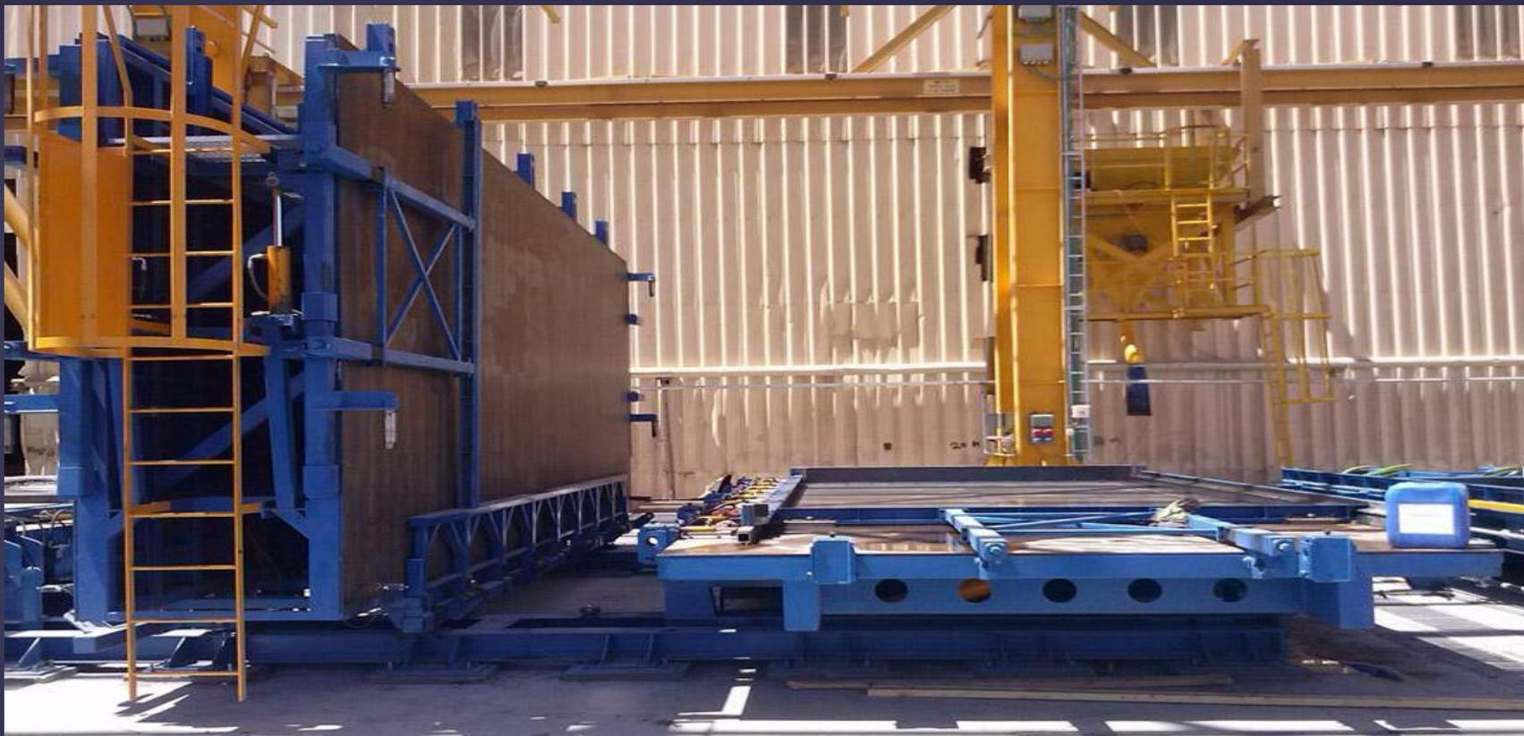
2-секционный поворотный вибростол - это гибрид универсального поворотного вибростола и кассетной установки.
