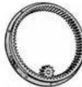
Прямозубая цилиндрическая передача с внутренним зацеплением
