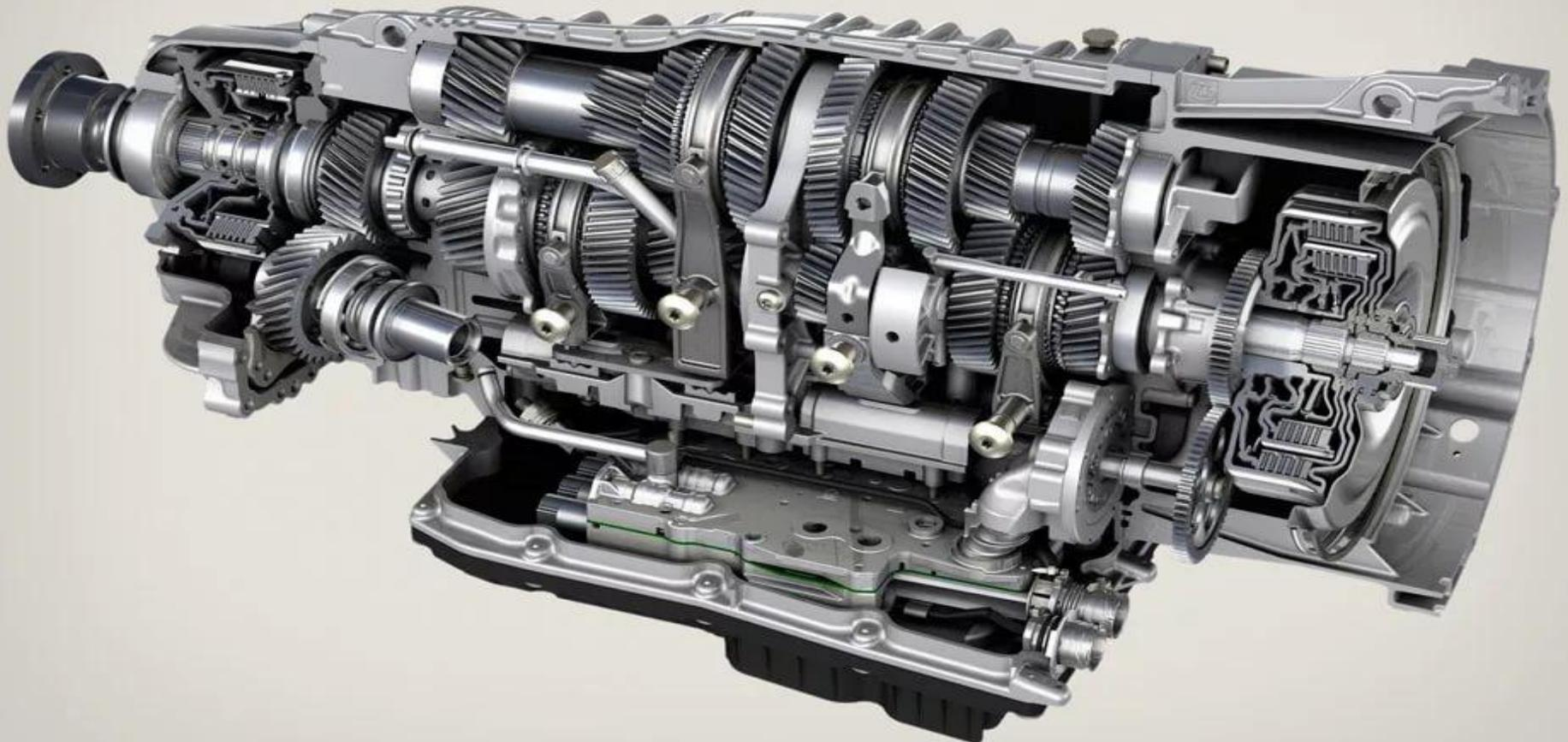
Коробка передач служит для изменения по величине и направлению передаваемого крутящего момента, длительного разъединения двигателя и трансмиссии во время стоянки или при движении автомобиля по инерции, а также для движения автомобиля задним ходом
