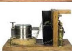
5 Прибор для обнаружения и регистрирования электромагнитных колебаний – первый в мире радиоприемник А. С. Попова. 1895 г.
