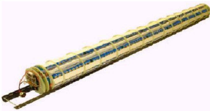
Батарея для подводной техники: 924 ЛИА.
