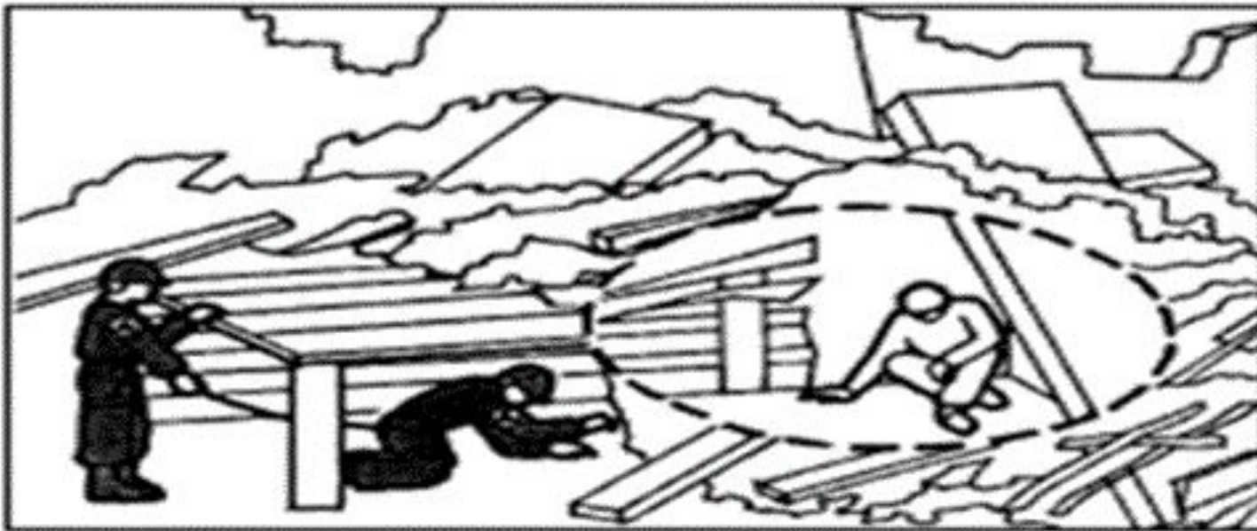
Устройство лаза в завале
