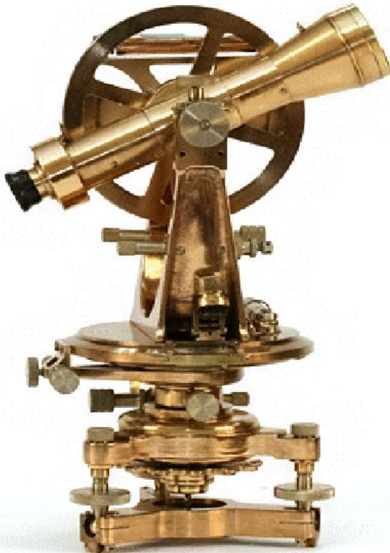
Теодолит оптический- это прибор для измерения как горизонтальных, так и вертикальных углов на местности. Этот прибор в своем развитии прошел длительный путь и вобрал в себя принципы действия таких приборов как гномоны, параллактические линейки, армиллы, астролябии, квадранты и другие.
