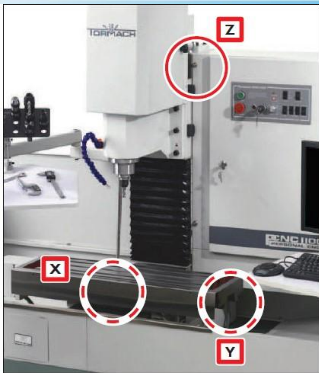
Бұл суретте – Жетектердің және кері байланыстың кіші жүйелері көрсетілген.
