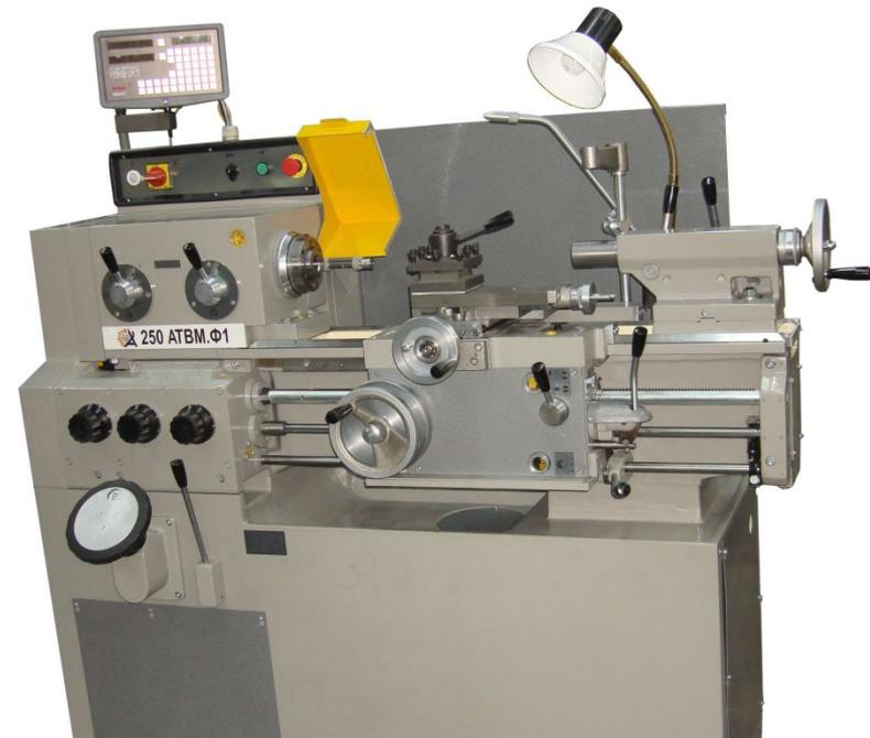
*Обтачивание наружных цилиндрических поверхностей; обтачивание наружных конических поверхностей; обработка торцов и уступов; про резание канавок и отрезание деталей; растачивание отверстий (цилиндрических и конических); сверление, зенкерование и развертывание отверстий; нарезание наружной и внутренней резьбы резцом, метчиком и плашкой; фасонное обтачивание; накатывание рифленых поверхностей.*
