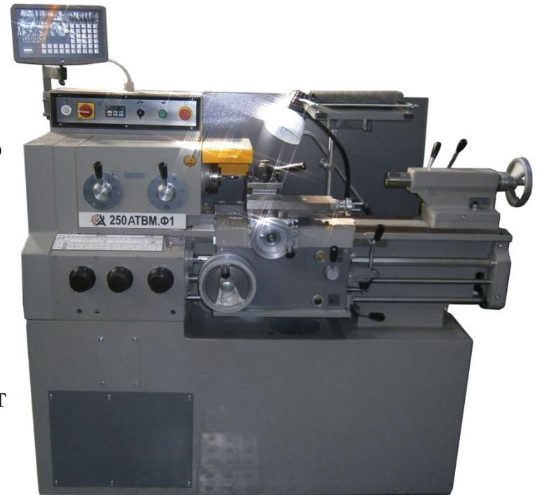
*Обтачивание наружных цилиндрических поверхностей; обтачивание наружных конических поверхностей; обработка торцов и уступов; про резание канавок и отрезание деталей; растачивание отверстий (цилиндрических и конических); сверление, зенкерование и развертывание отверстий; нарезание наружной и внутренней резьбы резцом, метчиком и плашкой; фасонное обтачивание; накатывание рифленых поверхностей.*
