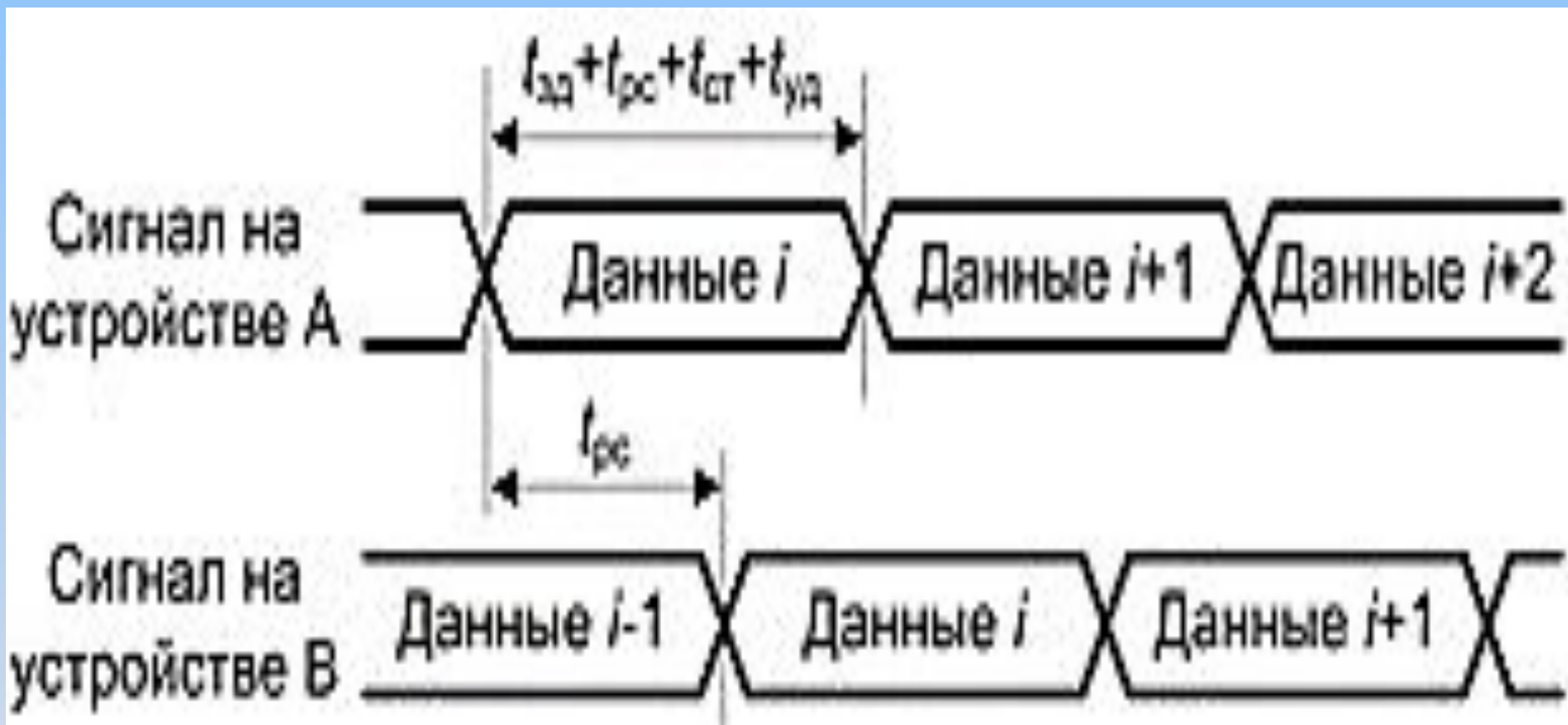
Рис. 5.17. Конвейеризация транзакций чтения
