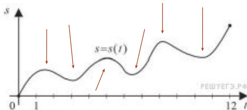
Мгновенная скорость равна производной перемещения по времени. Значение производной равно нулю в точках экстремума функции  $s(t)$ . Точек экстремума на графике 6.
