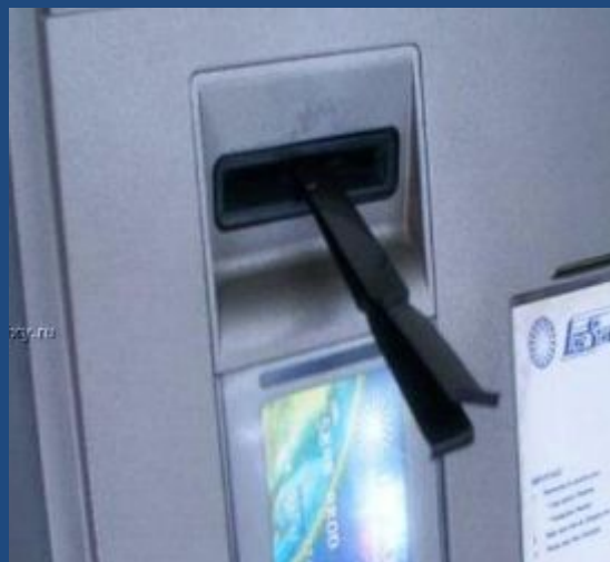
Ловушка делается из материала, используемого для рентгеновских снимков. Затем ловушка вставляется в банкомат
